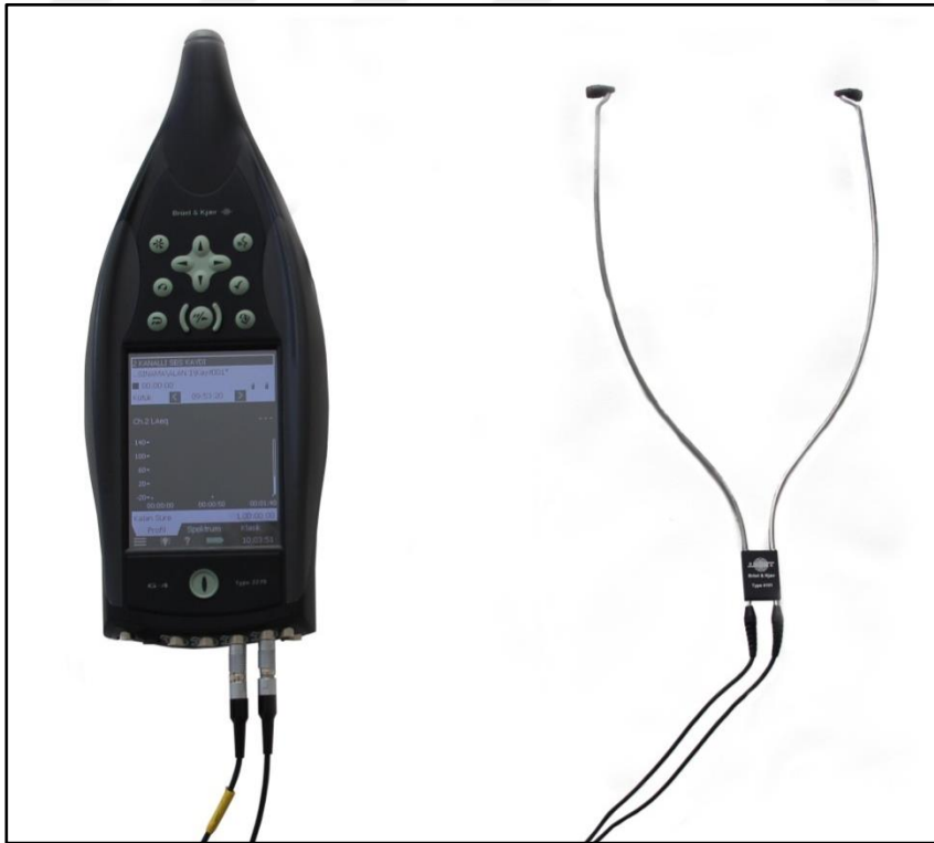
Şekil 4.2 : İki kulaklı ses kayıtlarında kullanılan ses ölçüm cihazı ve iki kulaklı mikrofon seti.
