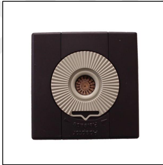
Şekil 4.5 : İki kulaklı ses kayıtlarına başlamadan önce ve kayıtları bitirdikten sonra mikrofonların kalibrasyonlarının gerçekleştirildiği ses düzeyi kalibratörü.
