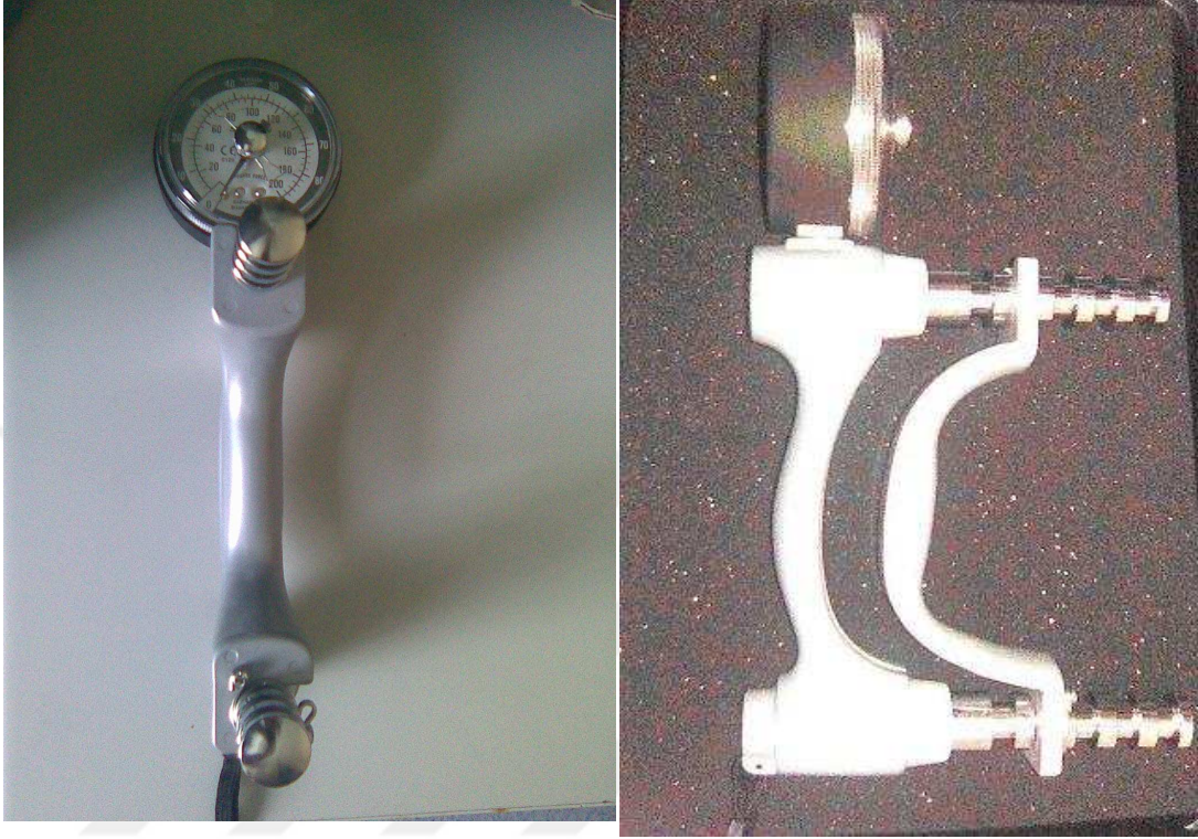
Resim 9: Kavrama gücü ölçmede kullanılan Hidrolik El Dinamometresi
