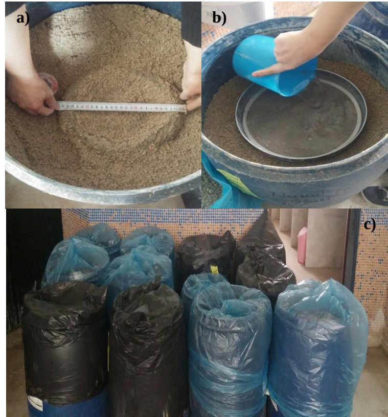
Şekil 3.36. a) Jet-grout kolonların çap kontrolü, b) Kolonların oluşturulduğu kum zeminin doygun hale getirilmesi ve c) Kalıpların üzerinin kapatılması
