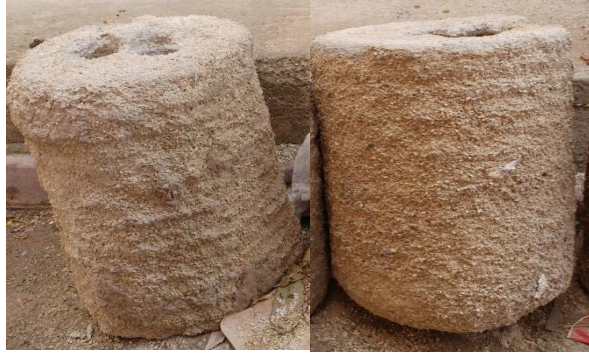
Şekil 4.2. SDÇ-NMS (6) ve SDÇ-SYS (6) kolonlarında meydana gelen spirallenme
