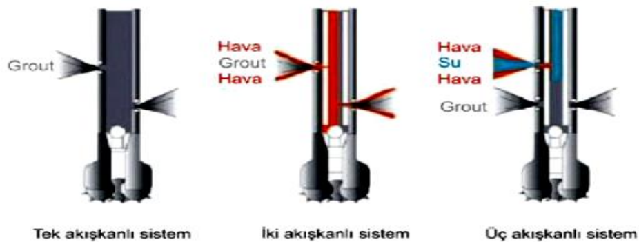
Şekil 3.4. Temel jet-grout sistemleri (Püsküllüoğlu, 2010)
