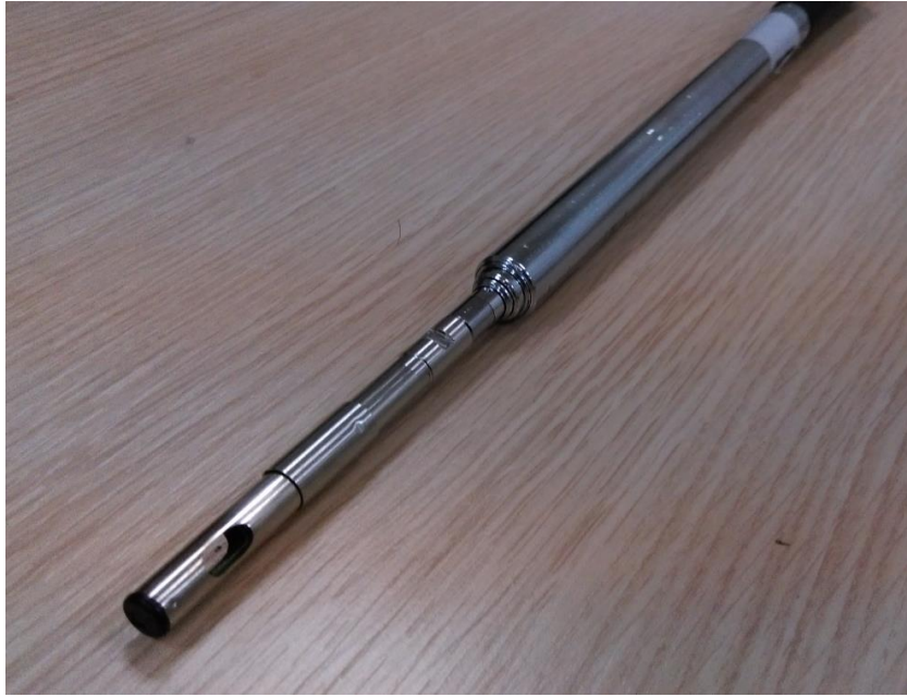
Şekil 3.4. AP471S1 sıcak tel probu
