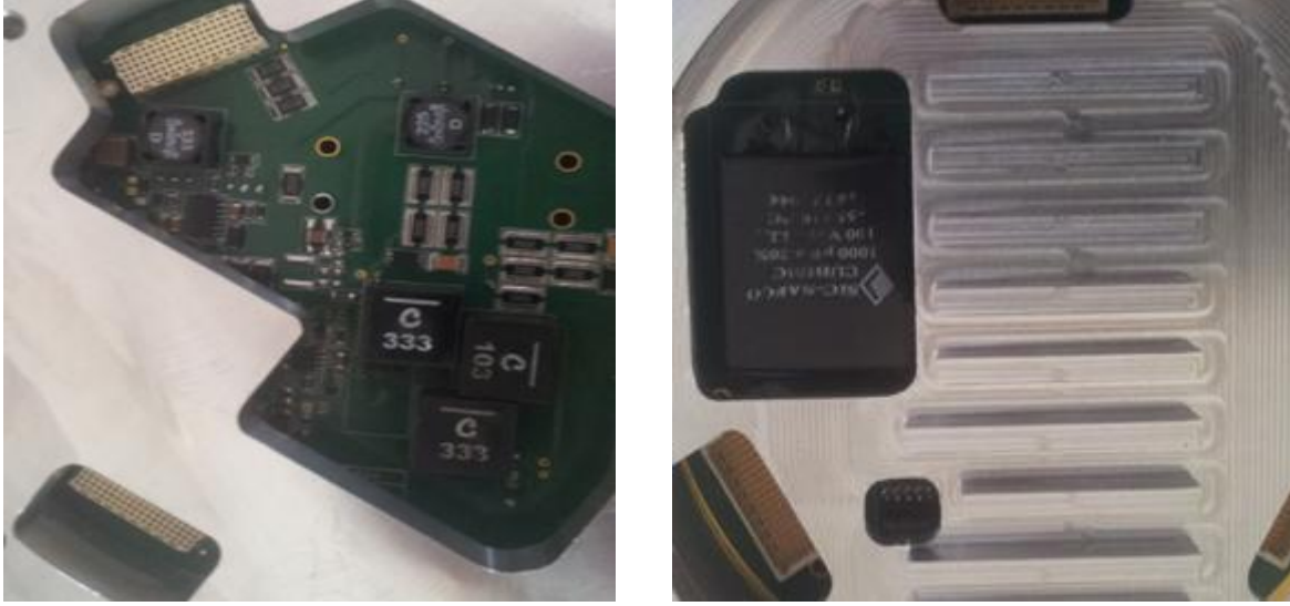
Resim 4.2. Tasarlanan BDK'ların soğutucularla birlikte üst ve alt taraftan görüntüleri
