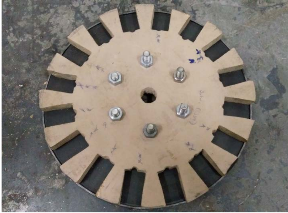
Şekil 3.10. Mıknatıs Yapıştırmaya Hazır Rotor Diski
