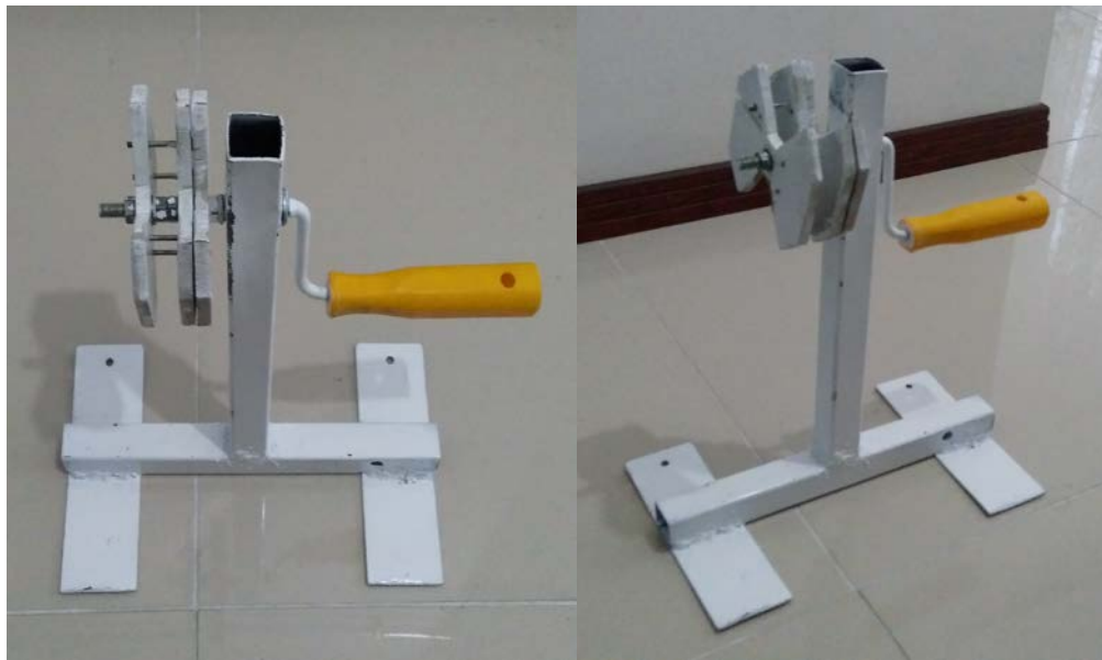
Şekil 3.2. Bobin Sarımı İçin Yapılan Sarma Aparatı
