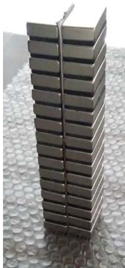
Şekil 3.8. Rotor Yapımında Kullanılan Mıknatıslar
