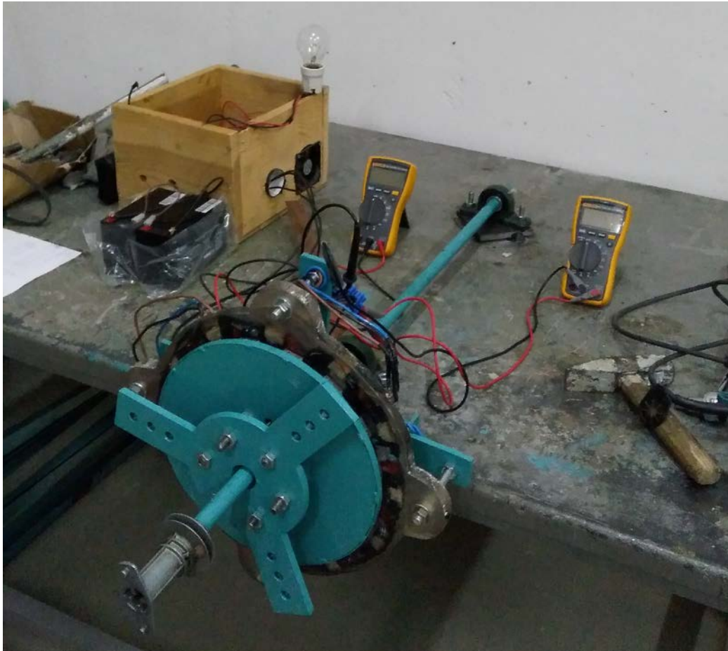
Şekil 3.16. Jeneratör Test Düzenegi
