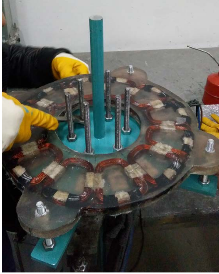
Şekil 3.14. Stator ve Rotorun Monte Edilmesi Esnasında
