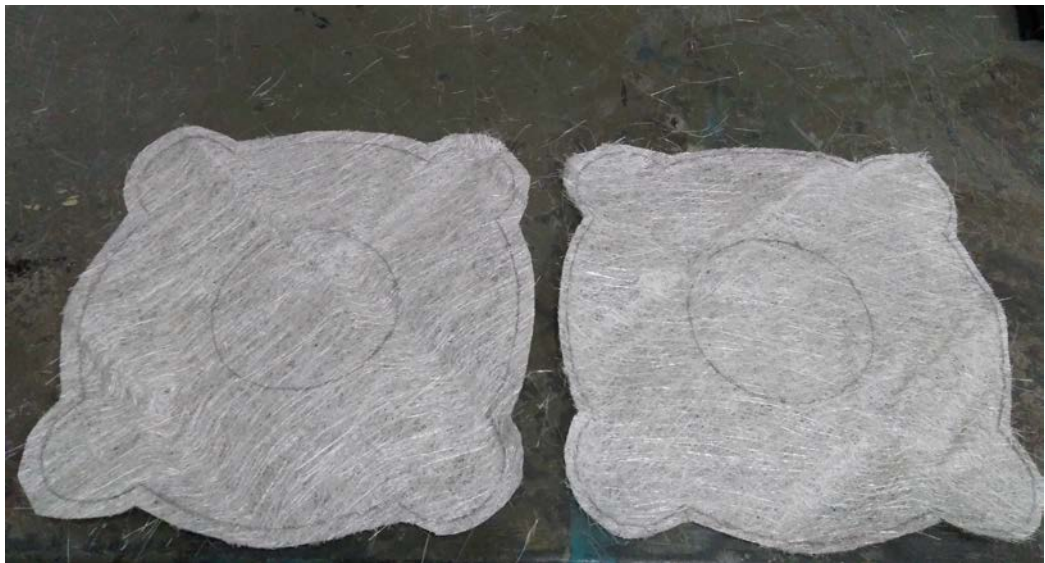
Şekil 3.6. Mukavemeti Artırmak Amaçlı Kullanılan Cam Elyaf
