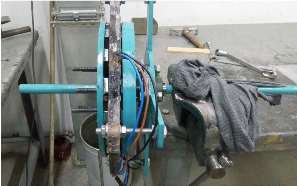
Şekil 3.15. Stator ve Rotorun Monte Edilmiş Hali
