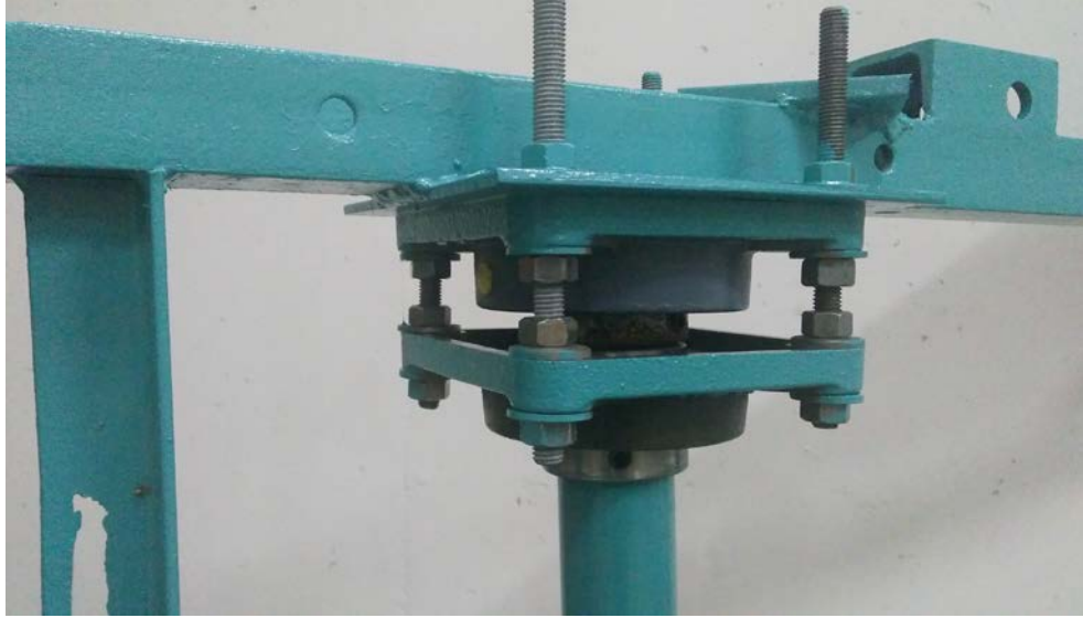
Şekil 3.17. Direğin Sabit ve Hareketli Kısımını Ayıran Rulmanlı Sistem
