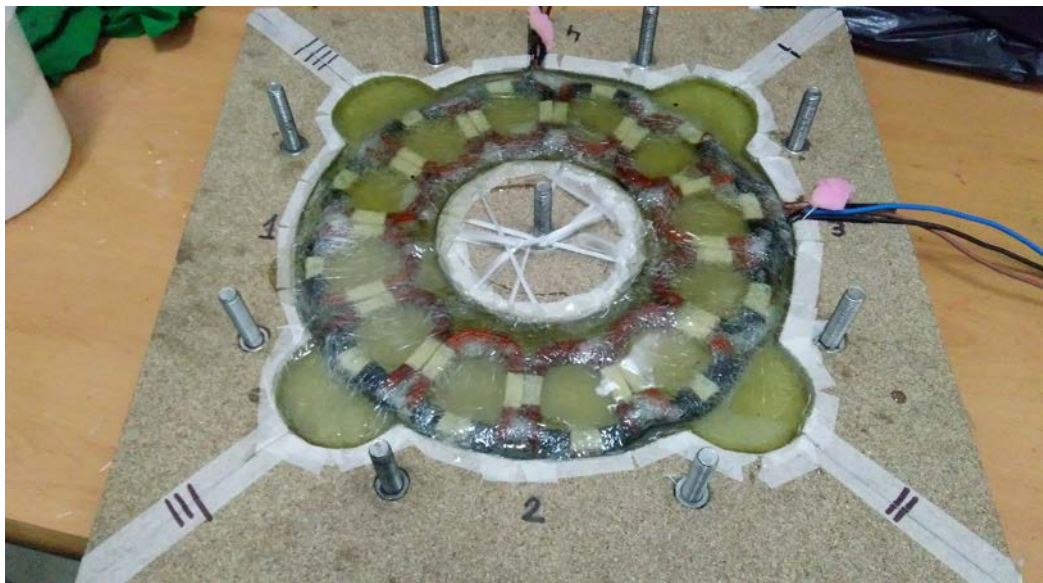
Şekil 3.4. Stator Kalıbına Yerleştirilmiş Bobinler
