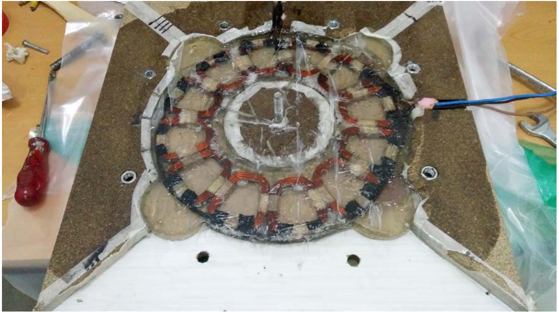
Şekil 3.5. Kuruyan Statorun Kalıptan Çıkarılmadan Önceki Görünümü
