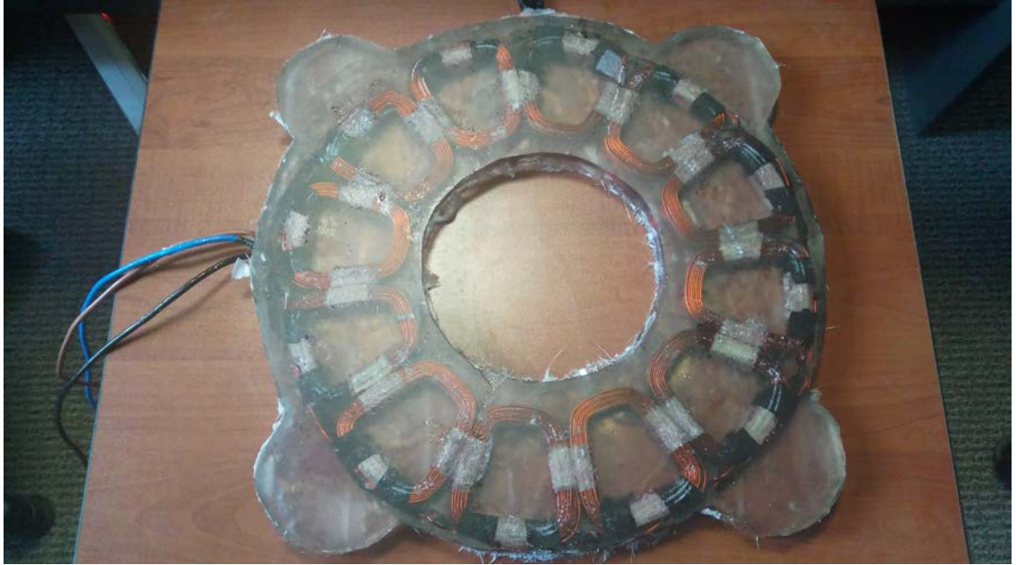
Şekil 3.7. Kalıptan Çıkarılan Stator
