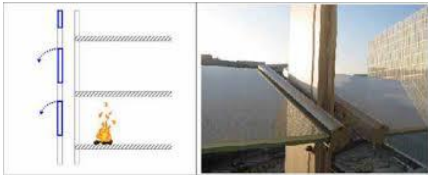
Şekil 3.18 : Jalousi sistemi ile duman kontrolü [40].
