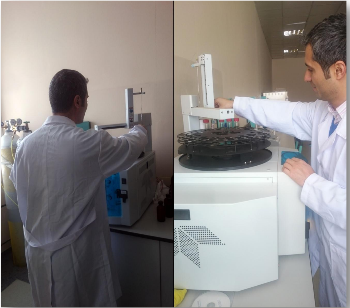
Şekil 3.6. Teledyne Tekmar Torch TOK Analiz Cihazı Görünümü (Teledynetekmar, 2016)
