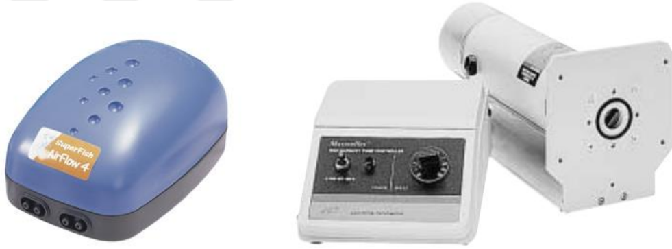
Şekil 4.16 Denemelerde kullanılan blower ve pompa
