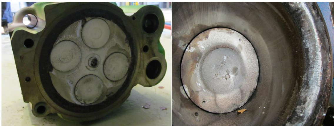
Şekil 3.8 Siloksan birikimi olan motor parçaları
