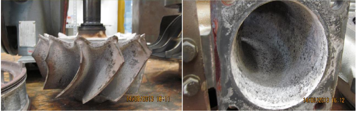
Şekil 3.9 Siloksan birikimi olan motor parçaları
