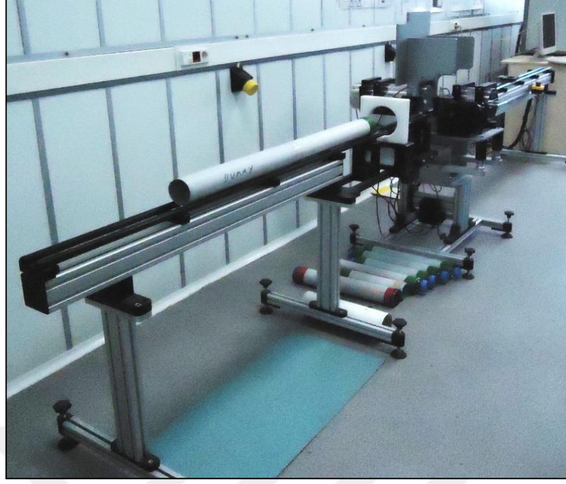
Şekil 2.9 : İTÜ-EMCOL laboratuvarındaki çok sensörlü karot log alıcısı.
