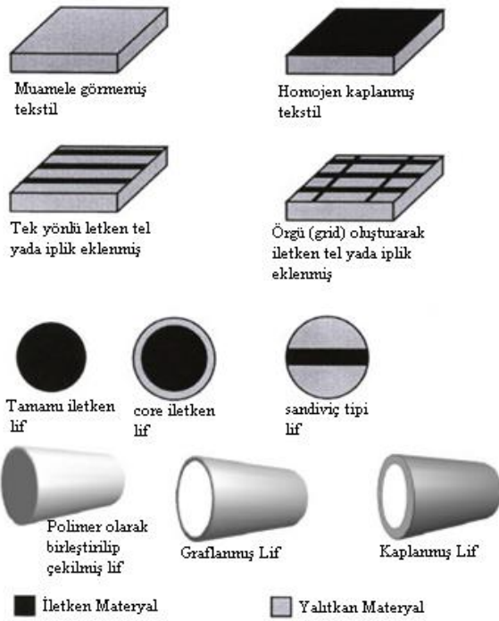
Şekil 1.6. Tekstil yapılarının iletken hale getirilmesi için kullanılan değişik yöntemlerin şematik gösterimi
