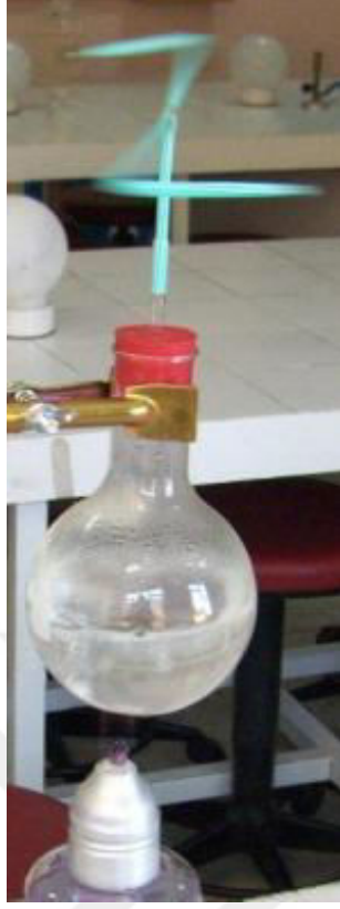
Sağda, Heron'un geliřtirdiđi buhar t rbini: Aeolipile (Resim kaynađı: Wikipedia)
