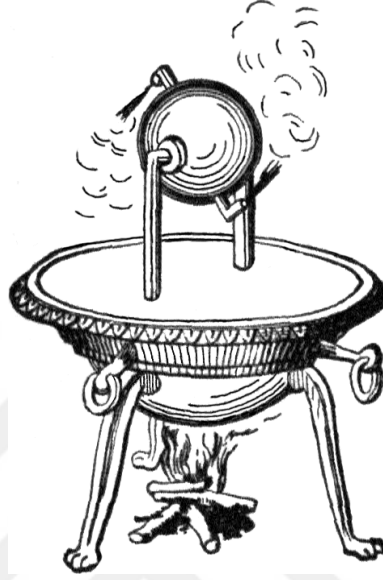
Sağda, Heron'un geliřtirdiđi buhar t rbini: Aeolipile (Resim kaynađı: Wikipedia)
