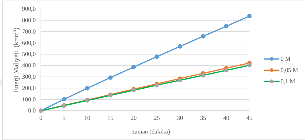
Şekil 5.9. Farklı destek elektrolit derişimlerinin enerji maliyetine etkisi, ( 20 \text{ mA/cm}^2 , deşarj pH: 8,32).
