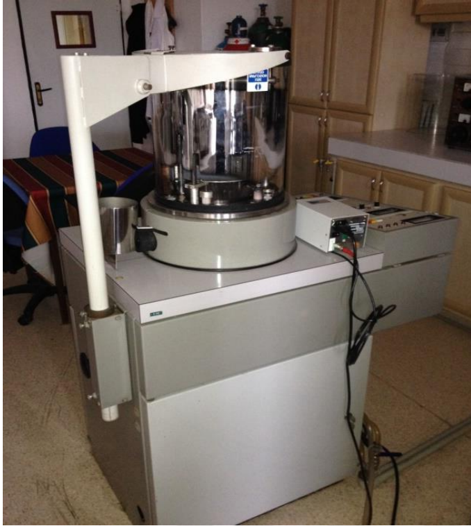
Resim 3.4. Al/ZnO/p-Si Schottky diyotların hazırlanması için kullanılan “Edwards” marka buharlaştırma sistemi
