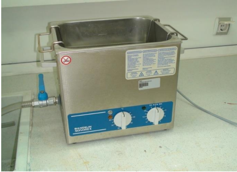
Resim 3.1. Beher Bandelin Sonorex marka ultrasonik banyo
