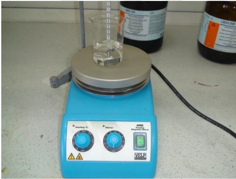
Resim 3.3. Kristal temizliđi aşamasında kullanılan ısıtıcı düzeneđi
