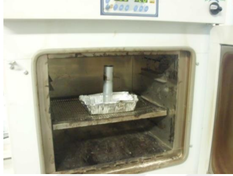
Şekil 6.3 Depolama stabilitesi bitm dolu tp numunesi
