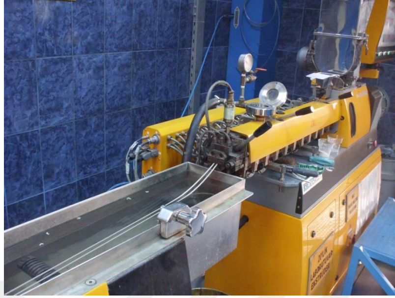
Şekil 7.10 Ekstrüderden çekilebilir hale gelen malzeme çıkışı
