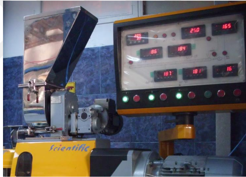
Şekil 7.11 Ekstrüder bölümleri sıcaklık değerleri
