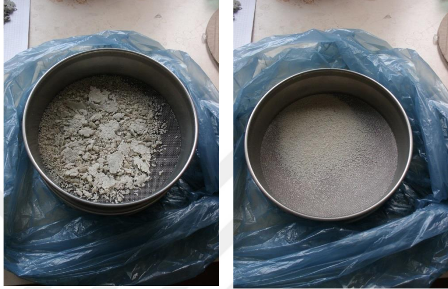
Şekil 7.15 Öğütülen malzemenin elekten geçirilmesi
