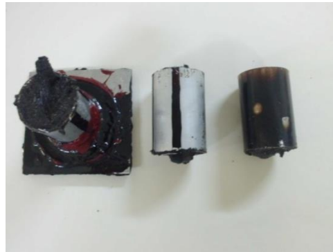
Şekil 6.4  eřit paraya blnmş bitm dolu tp numunesi
