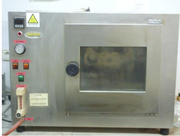
Şekil 6. 11 Dönel İnce Film Etüvü (RTFO) Cihazı
