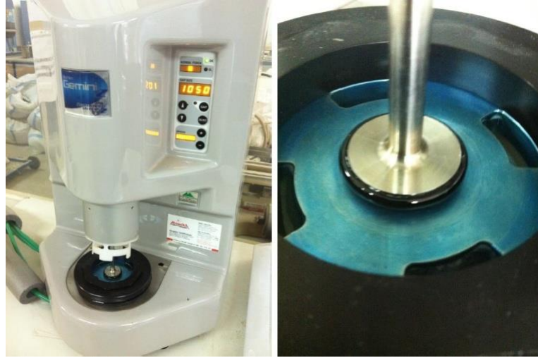
Şekil 6.13 Dinamik kesme reometresi (DSR) cihazı ve deney ekipmanları
