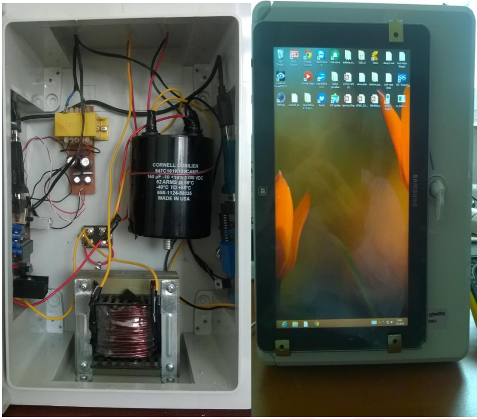
Şekil 5. 11: Boost konvertör ünitesi iç ve dış görünümü (Boost konvertör kontrol kartı, bobin, kondansatör, voltaj izleyici devre, tablet bilgisayar).
