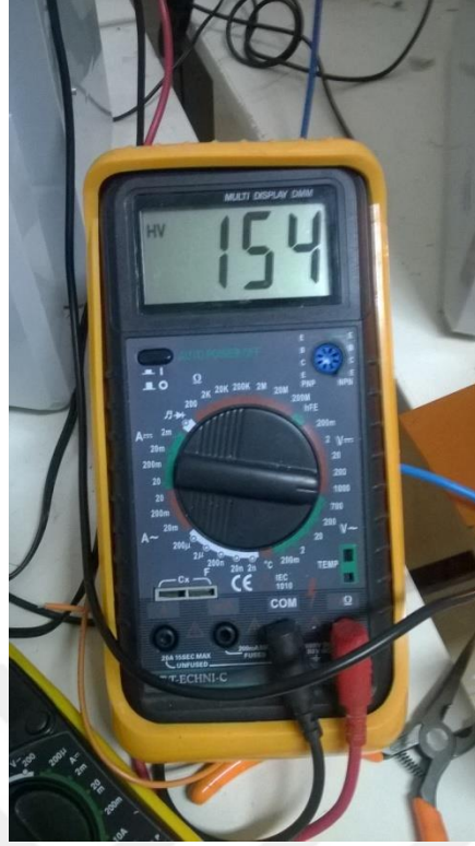
Şekil 6. 5.a: 12V giriş gerilimine karşılık %95 görev zamanında boost konvertör çıkış gerilimi (yük altında).
