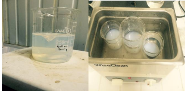
Şekil 3.5. Sol-jel üretimi aşamalarından bir görüntü. (Hidroliz sonrası, ideal renk ve akışkanlığa ulaşan sol-jel)
