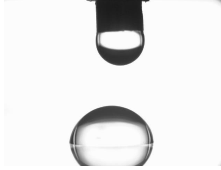
Şekil 4.4. Yüzey Temas açısı ölçümü sırasında cihazdan alınan örnek görüntü
