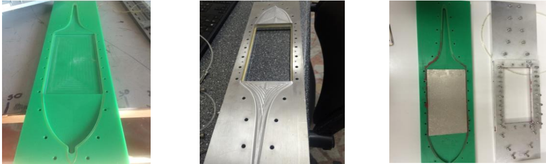
Şekil 3.9. PPL fotoreaktörü üst ve alt plakaların görünüşleri ve UV aydınlatma düzeneği
