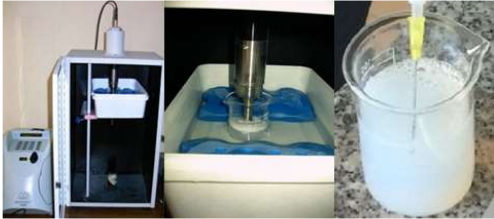
Şekil 2.1 Nanoakışkanın seyreltilmesi ve ses dalgalarıyla karıştırılması
