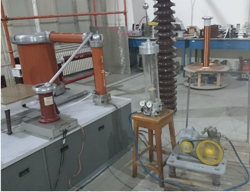
Şekil 4.35 : Alçak basınçta çubuk elektrot ile disk düzlem için KB ölçümü deney düzeneği.
