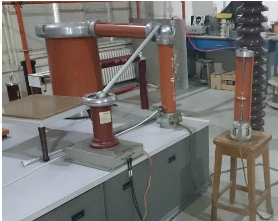
Şekil 4.6 : Çubuk elektrot ile disk düzlem KB ölçümü deney düzeneği.
