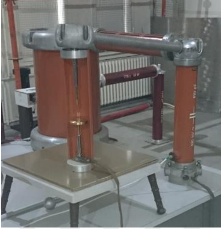
Şekil 4.4 : Çubuk elektrot ile düzlem atlama gerilimi ölçümü deney düzeneği.
