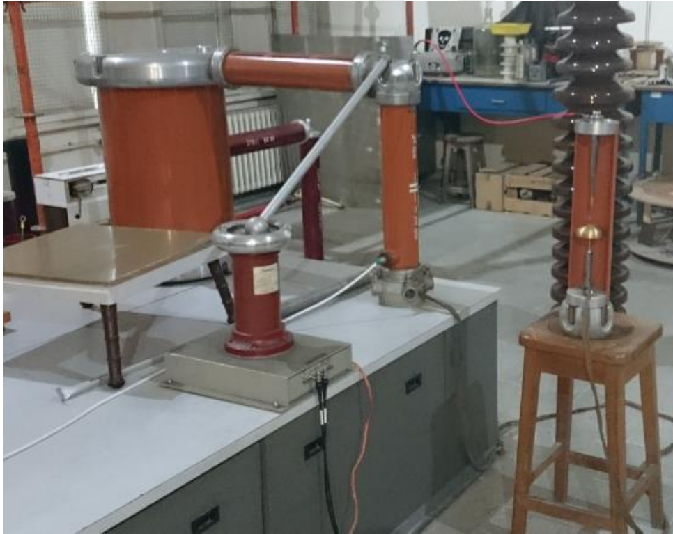
Şekil 4.22 : Çubuk elektrot ile Rogowski düzlem KB ölçümü deney düzeneği.
