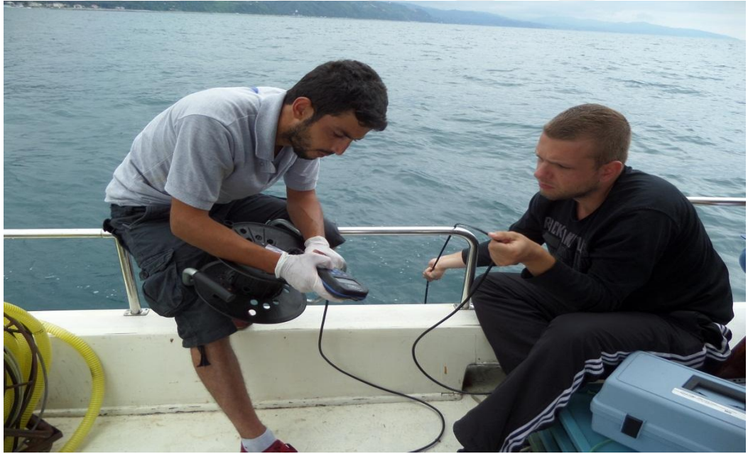
Şekil 3.2. DDD hattı deniz suyu numune alma ve CTD ölçümleri (Ardalı, 2015)
