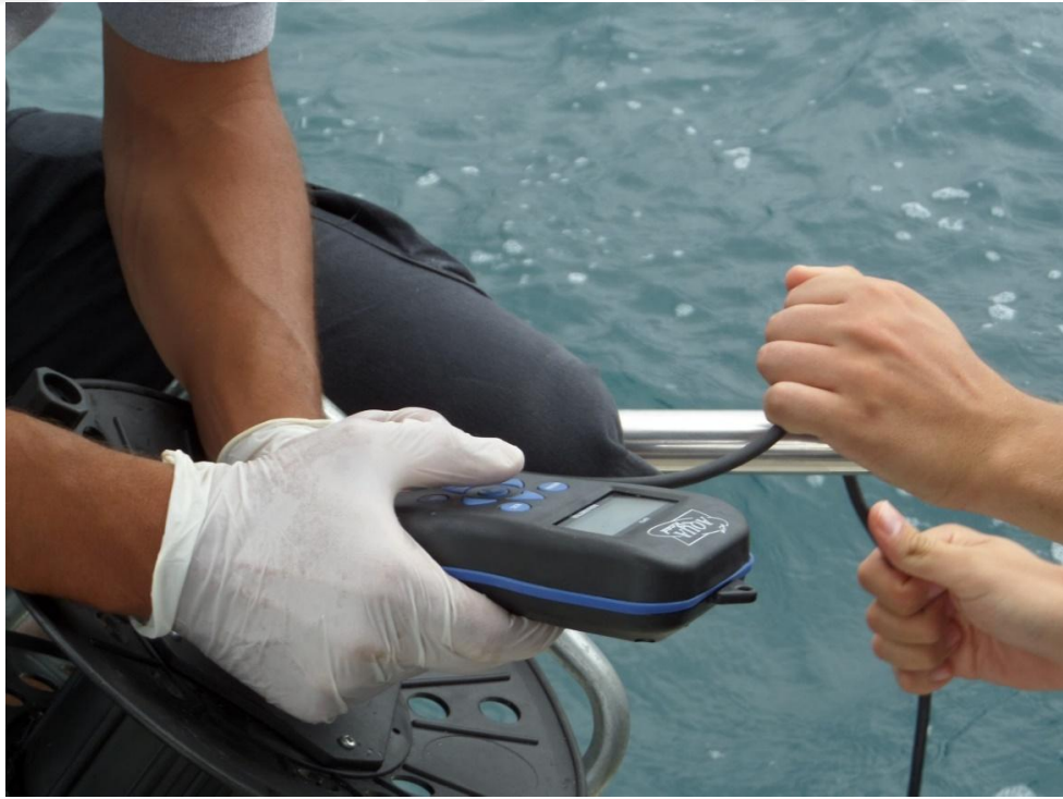
Şekil 3.4. DDD hattı deniz suyu numune alma ve CTD ölçümleri (Ardalı, 2015)
