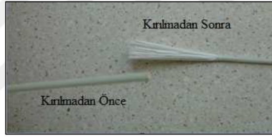
Şekil 3.6: Cam elyaf çubuğun kırılmadan sonraki saçaklanma durumu.
