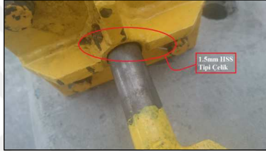
Şekil 4.3: 1.5mm HSS tipi çelik eklenmiş yay kutusu başlığı.
