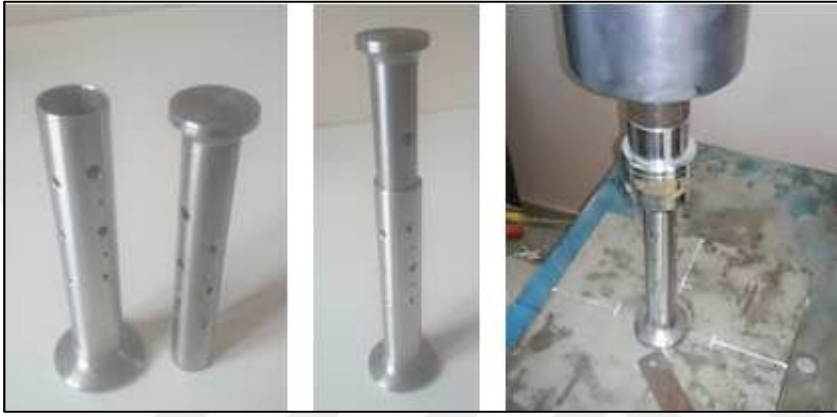
Şekil 3.1: Özel bir kayma kutusu şeklinde hazirlanan deney düzenegi.
