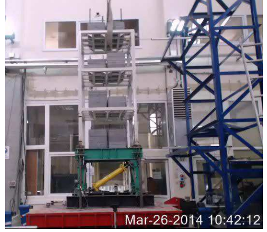
(b) ¼ oranında küçültülmüş olan ve sismik izolasyon katı üzerinde bulunan 3 katlı çelik yapı
