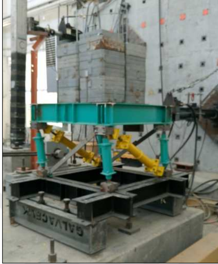
Şekil 5.20: İki kat yüklü izolatör katının MTS hidrolik veren'e bağlı itme-çekme deneyi.
