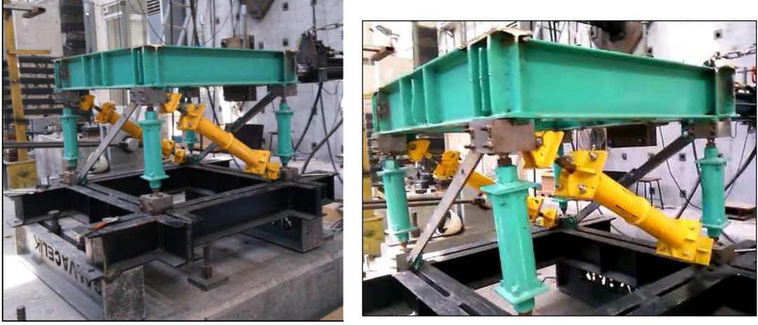
Şekil 5.11: İzolator katının yatay hidrolik veren (MTS)'e bağlı görüntüsü.
