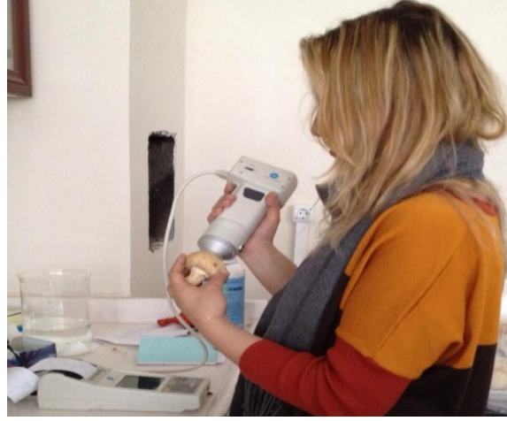
Şekil 3.2. Mantarlarda renk değişimlerinin Minolta CR-400 marka renk ölçer ile belirlenmesi.
