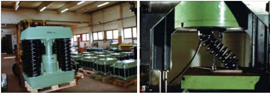
Şekil 1.11 : Viskoz sönümleyicili ve düşey helisel yaylı bir mesnet tipi (Url-4).
