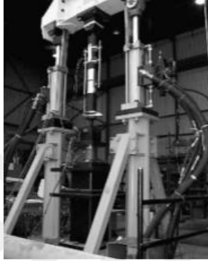
Şekil 1.7 : Büyük kapasiteli akışkan viskoz sönümleyici (Chang ve diğ, 2002).
