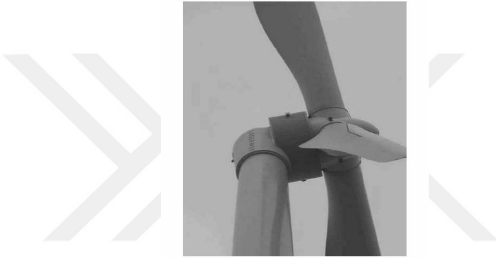
Şekil 2.6. Kalıcı mıknatıslı senkron jeneratörlü doğrudan sürülen rüzgâr türbini
