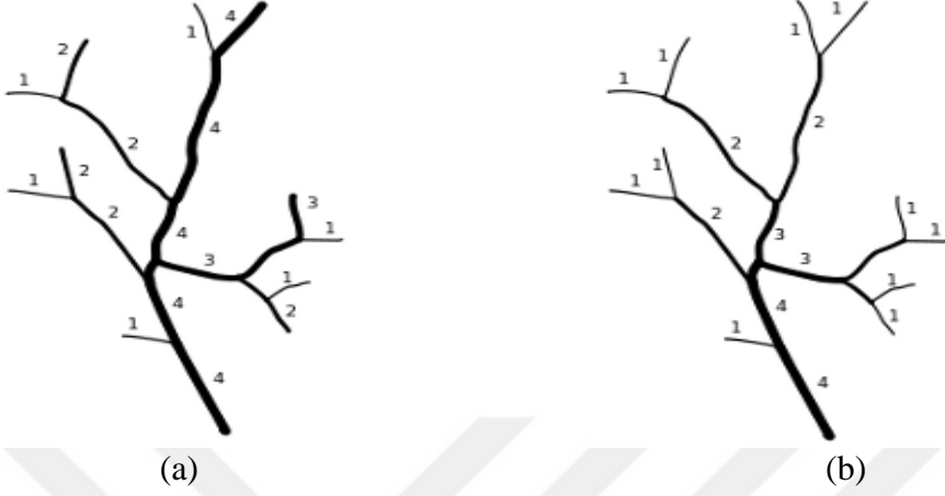
Şekil 1.3 : Horton (a) ve Strahler (b) tarafından geliştirilen akarsu mertebelenendirme metodları (Url-7).
