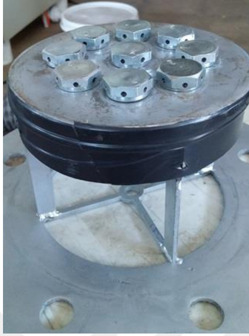
Şekil 5.15 : Kısa ve 90°'lik kanallı nozullar
