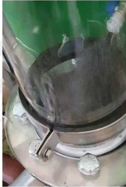
Şekil 5.22 : Meş gaz dağıtıcılı sisteminde düzensiz akışkanlaşma (dengesiz akışkanlaşma)
