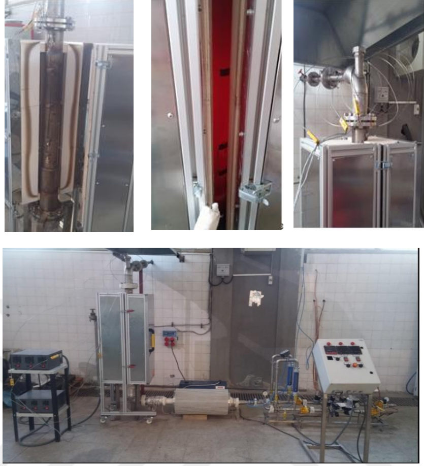
Şekil 5.48 : İmalat aşaması tamamlanmış AY ve ısıtma fırınının görüntüleri
