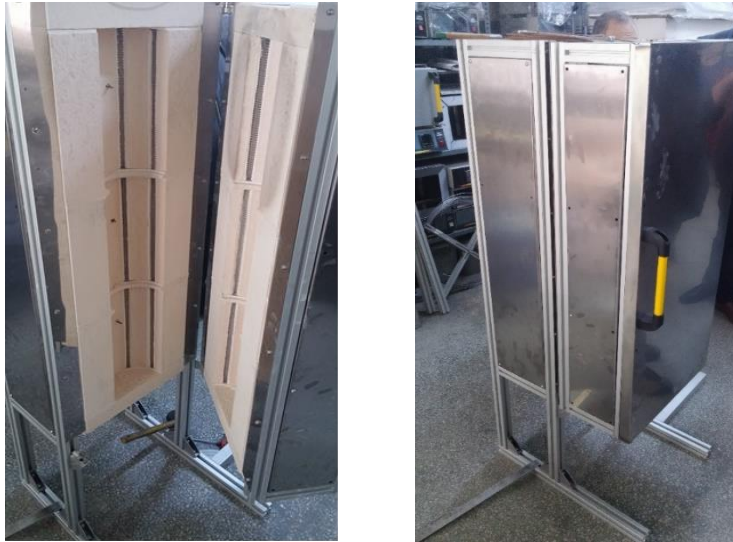
Şekil 5.43 : Isıtma sistemine ait 3 zon ve deney sonrası hızlı soğutmayı sağlamaya yönelik tasarlanmış açılır kapılı konstrüksiyonel fırın yapı
