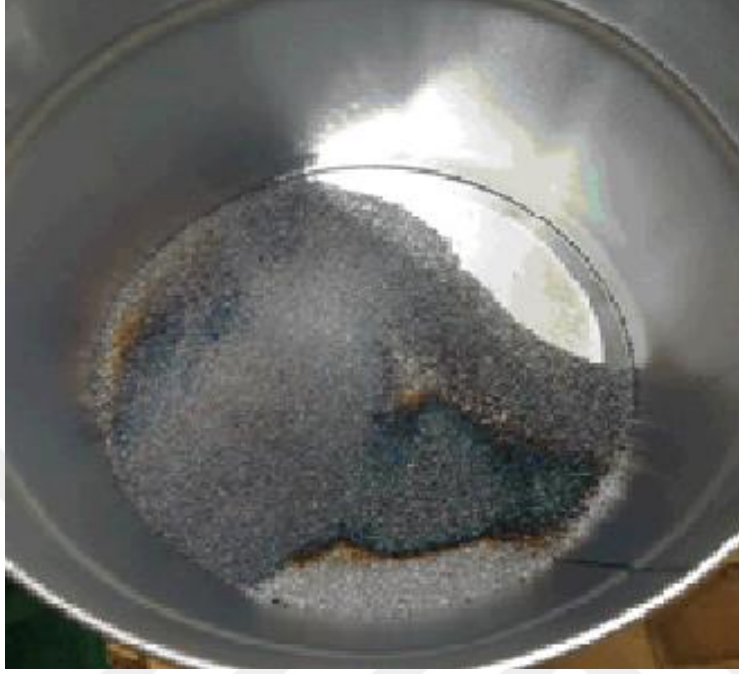
Şekil 6.7 : Bu tez çalışmasında kullanılan benzer malzemeler ile gerçekleştirilen pilot boyutlu bir çalışma sonrasında kontrol edilemeyen geri oksidasyon [45]
