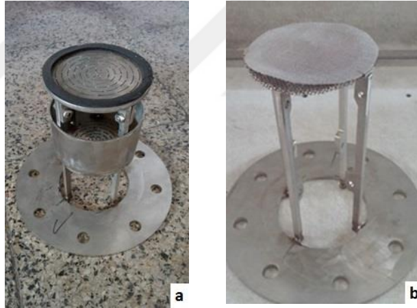
Şekil 5.24 : Gaz dağıtıcı sistemleri (a) Sürekli kanallı dağıtıcı (b) Meş sistemi
