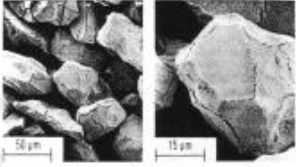
Şekil 2.5 : Hematitten redüksiyon sonucu oluşan manyetit yapısı [14]
