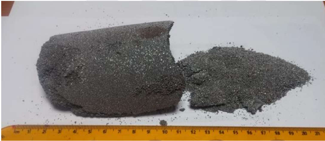
řekil 6.16 : 725°C’ de yapılan deney sonrası reaktrden ıkan bloklařmıř numune [16 m 3 /sa 120 dk. %40 H 2 ]
