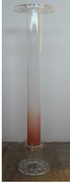
Şekil 5.23 : 80mm çaplı 1200 mm uzunluğundaki pleksiglas soğuk akışkan yatak
