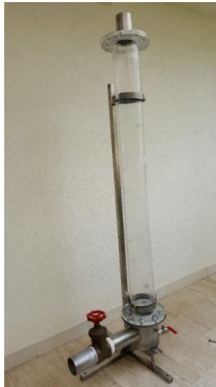
řekil 5.6 : Ø 140mm ve 1500 mm ykseklikte pleksiglas soėuk akıřkan yatak modeli
