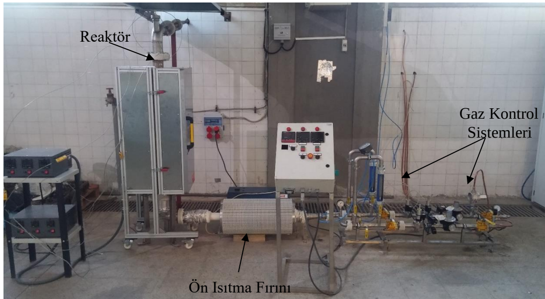
Şekil 5.5 : Tez çalışmasında tasarımı ve imalatı gerçekleştirilen ülkemizin hidrojen redüksiyonuna uygun ilk Akışkan Yatak Fırını
