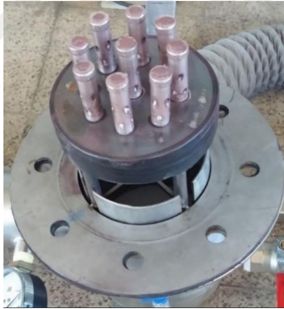
Şekil 5.12 : 30° ve 45° açılı 8 adet delik açılan nozullar
