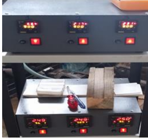
Şekil 5.44 : Sıcaklık ölçüm sistemi (Üst taraf reaktör içi alt taraf direnç tarafı olmak üzere 6 zon)
