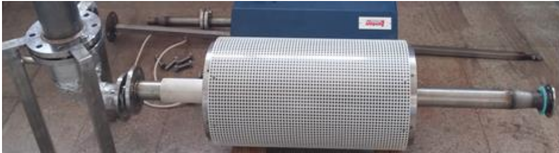
Şekil 5.47 : Reaktif ve taşıyıcı gaz ön ısıtma sistemi
