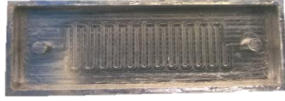
Şekil 3. 2 Mikroreaktör üretiminde kullanılan kalıp
