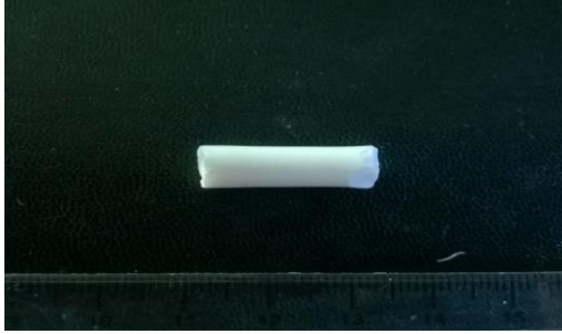
Şekil 4. 2 Süperkritik \text{CO}_2 kurutma sonrası aljinat-silika hibrit monolit
