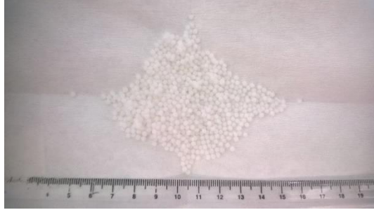
Şekil 4. 1 Süperkritik CO 2 ile kurutma sonrası aljinat-silika hibrit boncuklar
