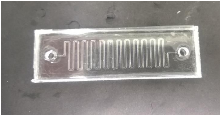
Şekil 3. 3 100 µl hacme sahip PDMS mikroreaktör
