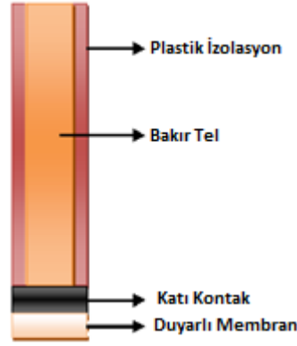
Şekil 1.1. Klasik bir PVC-membran iyon seçici elektrot
