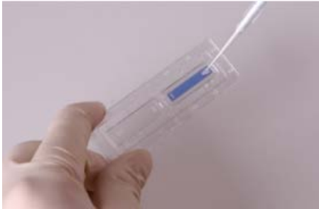
Şekil 3-2: Luna Otomatik Hücre Sayımı cihazı slaytı.
