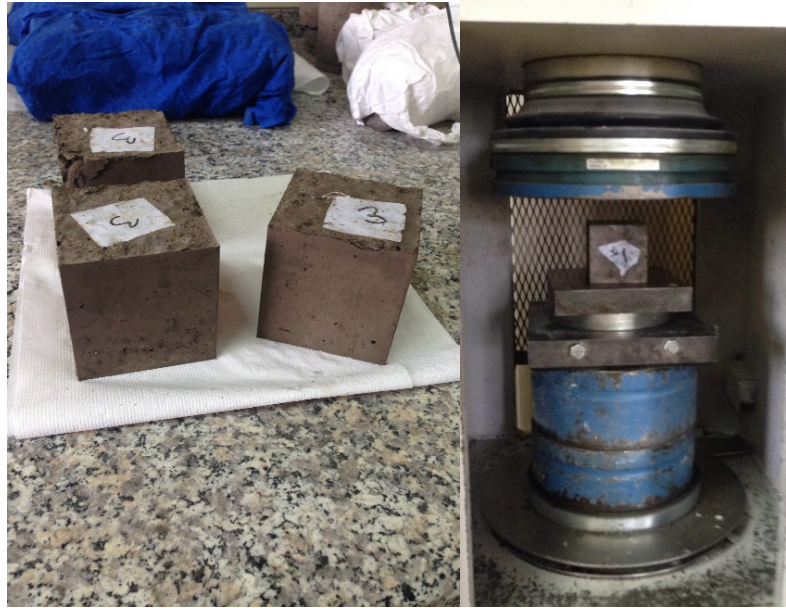
Şekil 5.15 Numunenin prese yerleştirilmesi
