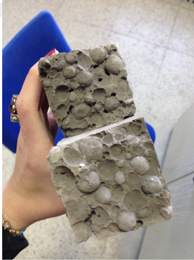
Şekil 6.14 Hafif beton numunesinin eğilme dayanım testi sonrası kırılma yüzeyi
