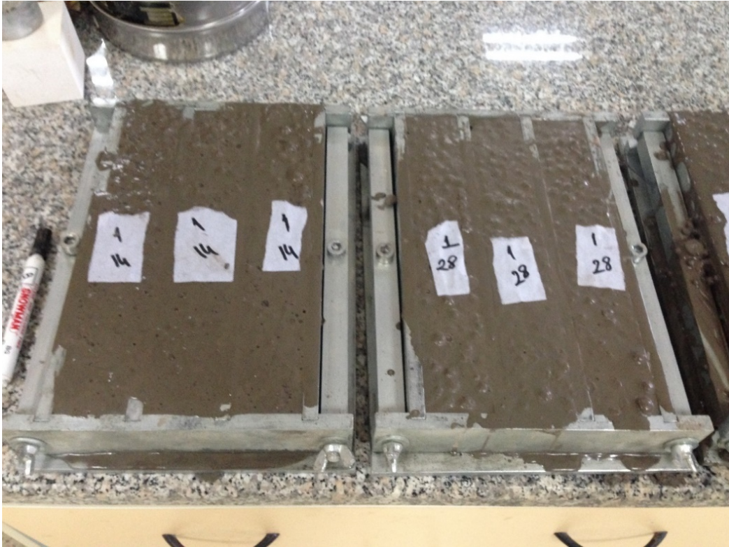
Şekil 5.16 Hafif beton karışımının kalıplara doldurulması
