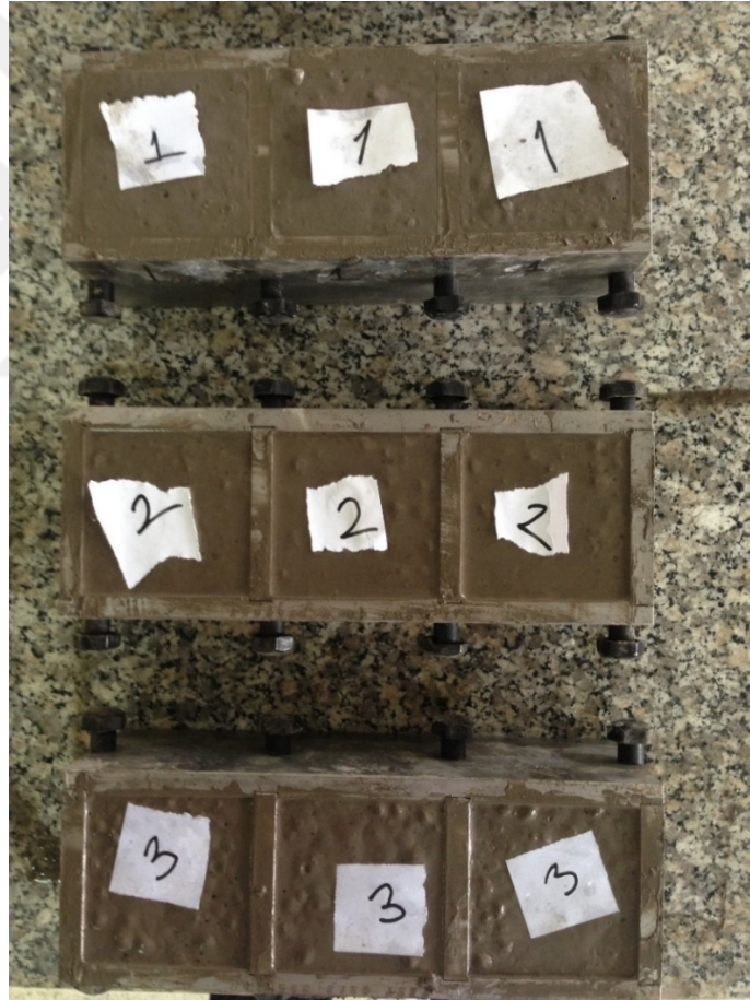
Şekil 5.13 Hafif beton karışımının kalıplara doldurulması
