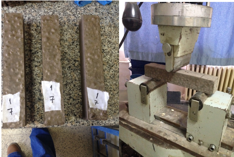
Şekil 5.18 Numunenin prese yerleştirilmesi
