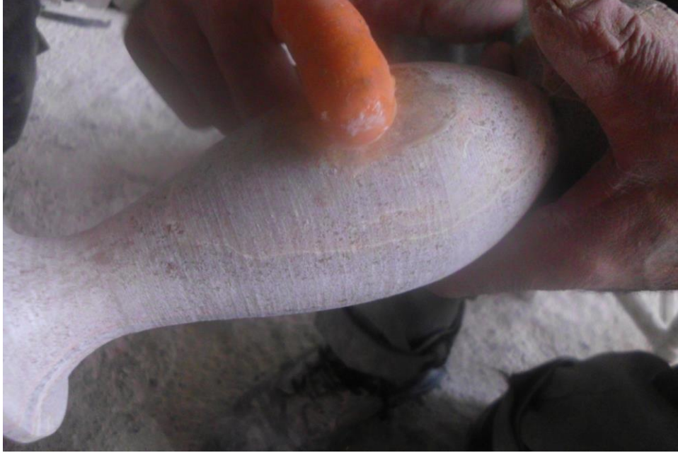
Şekil 43. Gözeneklerin Kapatılması, Arı Oniks Atölyesi, 2014
