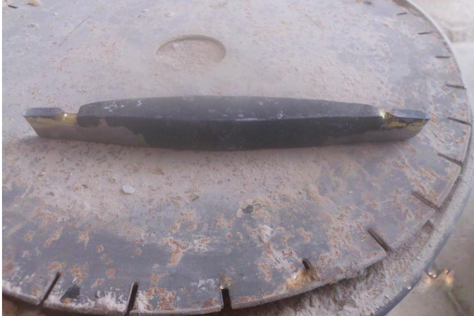
Şekil 39. Ürünün Dış Kısmını Şekillendirmeye Yarayan Talaş Kalemi, Arı Oniks Atölyesi, 2014
