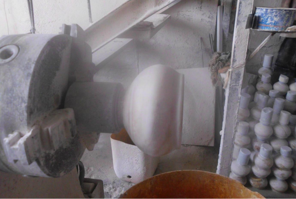
Şekil 45. Zımparalanacak Ürünün Makineye Takoz Kısmından Sıkıştırılması, Arı Oniks Atölyesi, 2014
