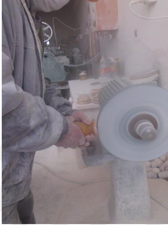
Şekil 48. Takozdan Ayrılan Ürünün Ayrılma Yerinin Düzeltilmesi, Arı Oniks Atölyesi, 2014
