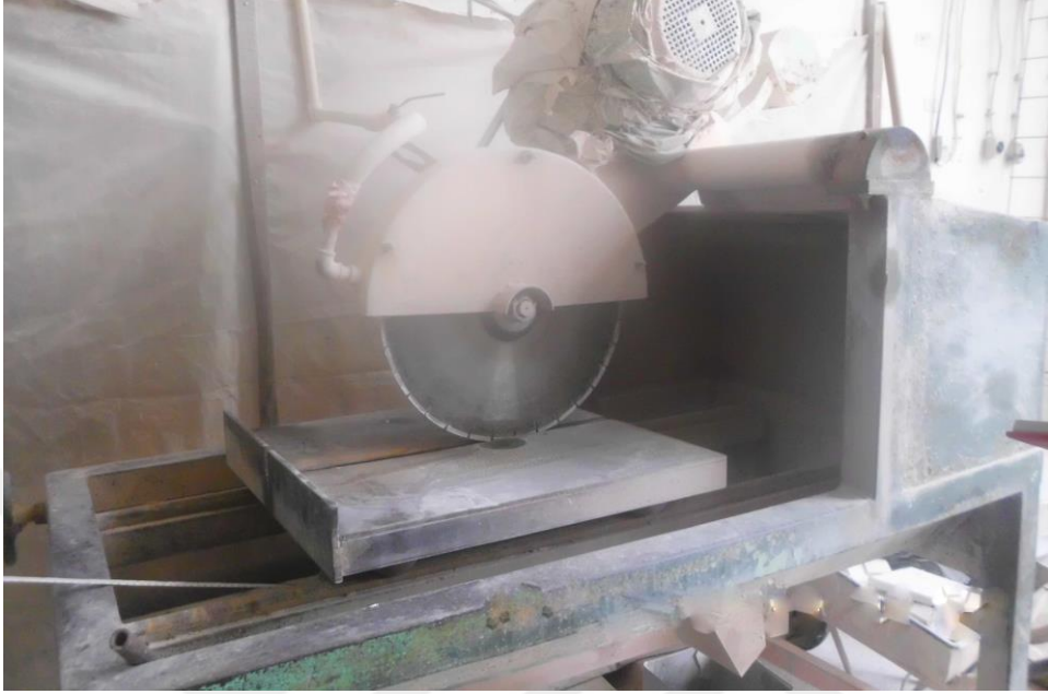
Şekil 32. Kaya Halindeki Oniks Taşının 45cm'lik Taş Kesme Makinesinde Küçültülmesi, Arı Oniks Atölyesi, 2014
