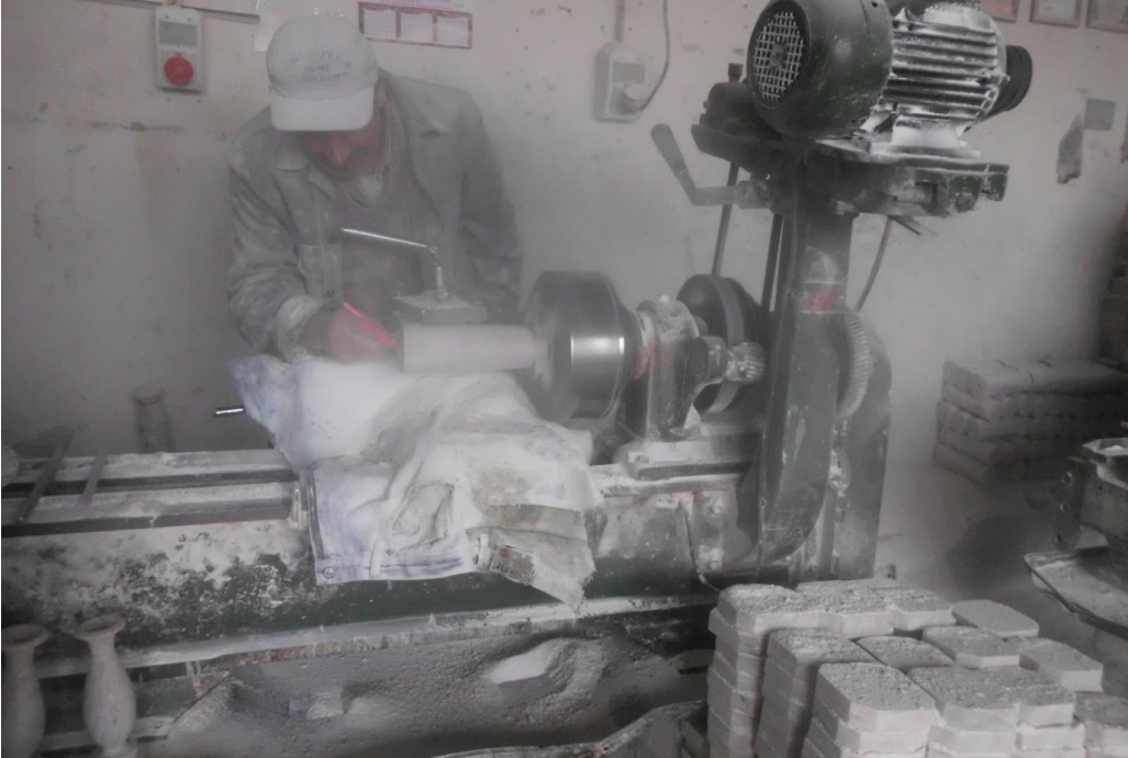
Şekil 35. Çalışılacak Ürünün Tam Orta Noktasının Belirlenmesi, Arı Oniks Atölyesi, 2014
