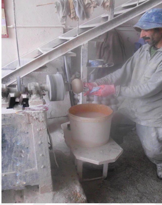
Şekil 46. Ürünün Zımparalanması, Arı Oniks Atölyesi, 2014
