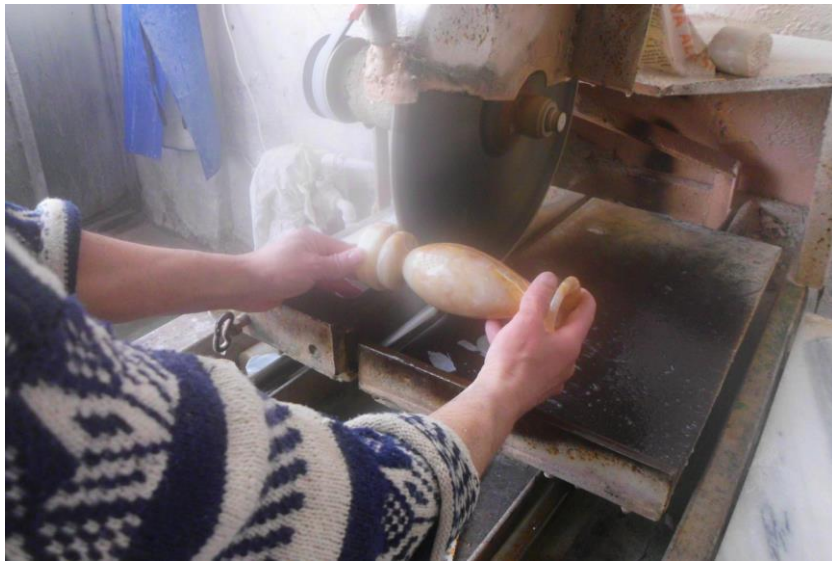
Şekil 47. Parlatılan Ürünün Takozdan Ayrılıp Yıkınması, Arı Oniks Atölyesi, 2014
