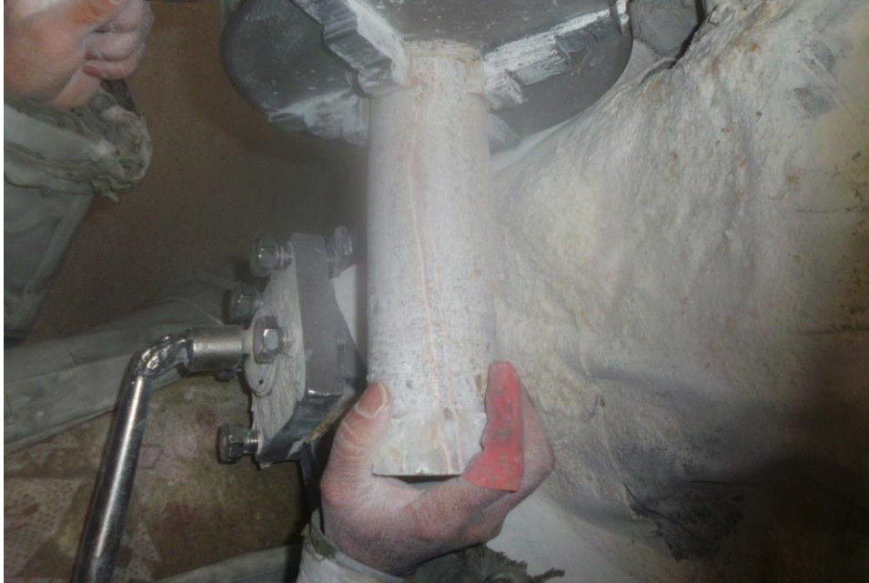
Şekil 37. Üzerinde Çalışılacak Ürünün Torna Makinesine Sıkıştırılması, Arı Oniks Atölyesi, 2014
