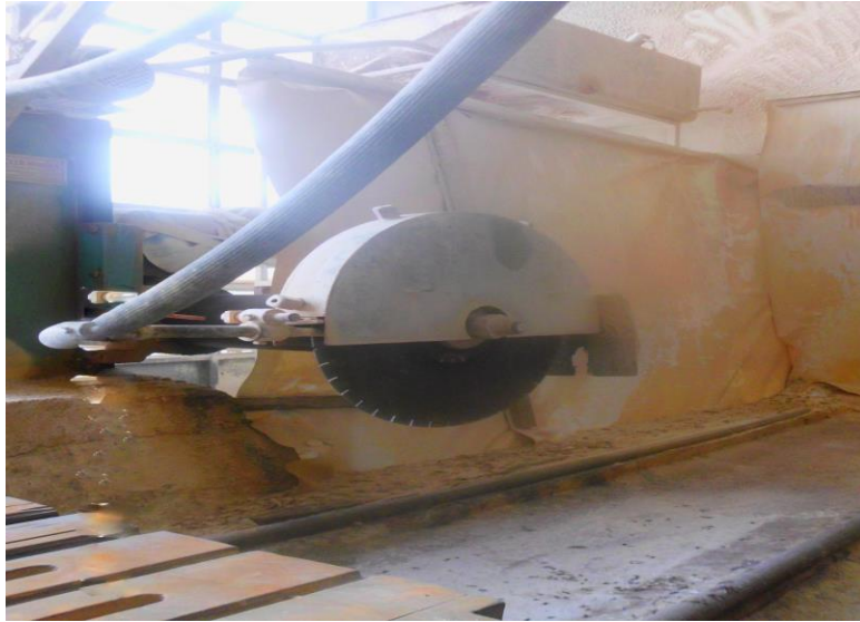
Şekil 31. Kaya Halindeki Oniks Taşının 60 cm'lik Dişli Taş Kesme Makinesinde Küçültülmesi, Arı Oniks Atölyesi, 2014
