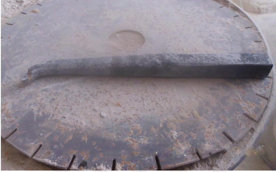
Şekil 38. Ürünün İç Kısmını Boşaltmaya Yarayan Eğri Kalem, Arı Oniks Atölyesi, 2014
