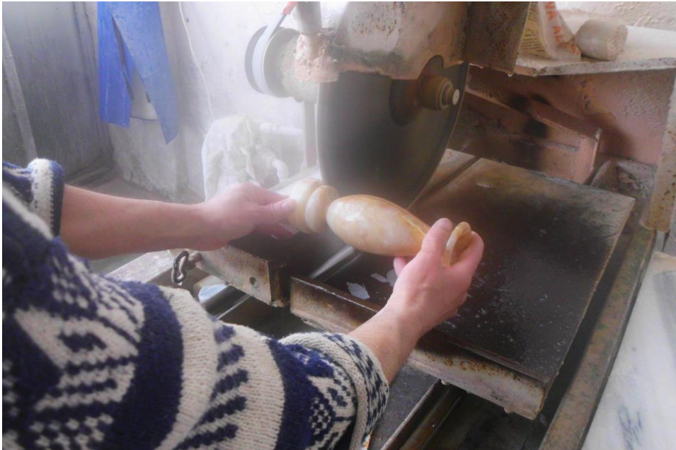
Şekil 27. Yıkama- Kesme Tekniği, Arı Oniks Atölyesi, 2014
