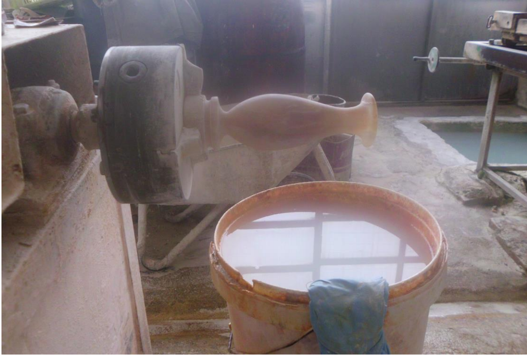
Şekil 20. Asit – Kalay Karışımı, Arı Oniks Atölyesi, 2014
