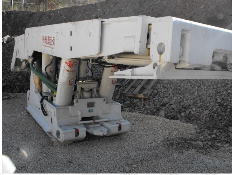
Şekil 3.4 Kalkan tipi (Lemniskat) yürüyen tahkimat
