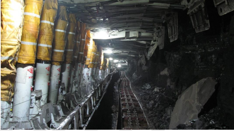
Şekil 2.2 Tam mekanize çalışan bir uzun ayağın görünüşü
