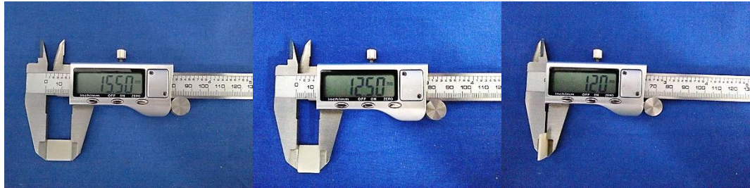
Şekil 2.2. Örneklerin final boyutlarının ölçümü
