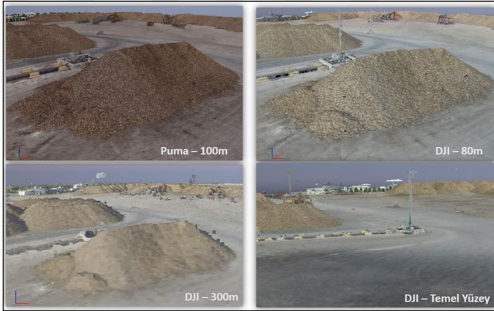
Şekil 4.33 : Farklı parametrelerdeki silo yığını nokta bulutu.
