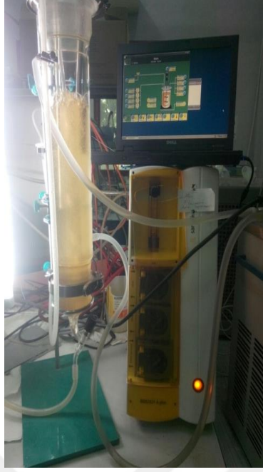
Şekil 3.2.Hava kaldırmalı fotobiyoreaktörde yapılan Phaeodactylum tricornutum üretimi.
