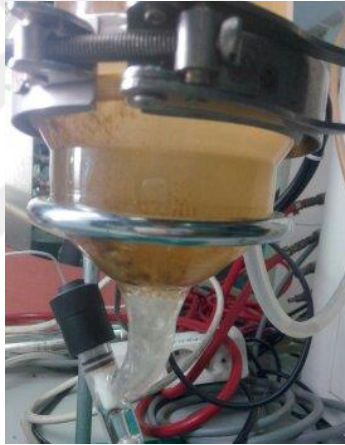
Şekil4.20. Hava kaldırmalı fotobiyoreaktörde Phaeodactylum tricornutum hücrelerinin çökmesi sorunu
