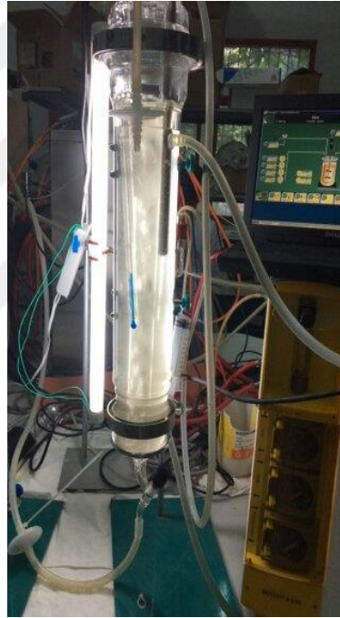
Şekil 4.17. Hava kaldırmalı fotobiyoreaktörde Phaeodactylum tricornutum üretimleri
