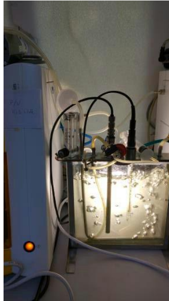
Şekil 3.3.Panel fotobiyoreaktörde yapılan Phaeodactylum tricornutum üretimi.
