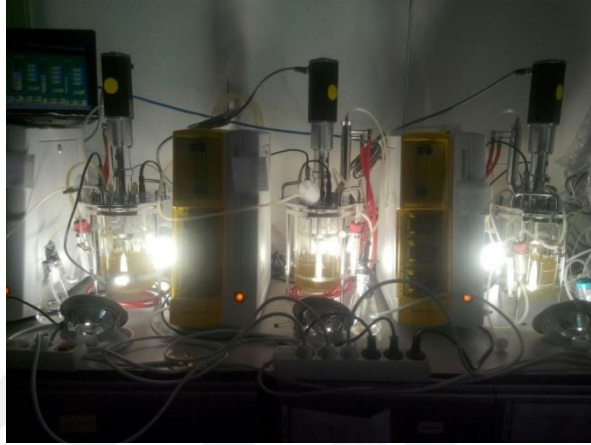
Şekil 3.1. Karıştırmalı tank fotobiyoreaktörde yapılan Phaeodactylum tricornutum üretimleri.
