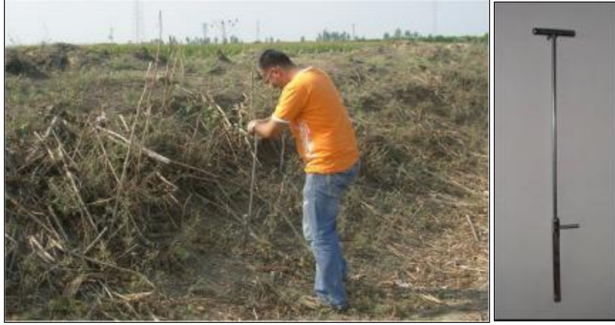
Şekil 3.11. Arazi çalışmalarında kullanılan toprak örneği alma aleti.
