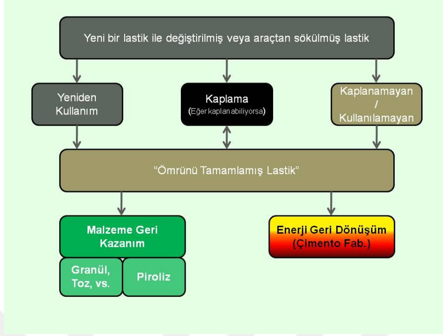
Şekil 2.2 ÖTL geri kazanım yöntemi [22].
