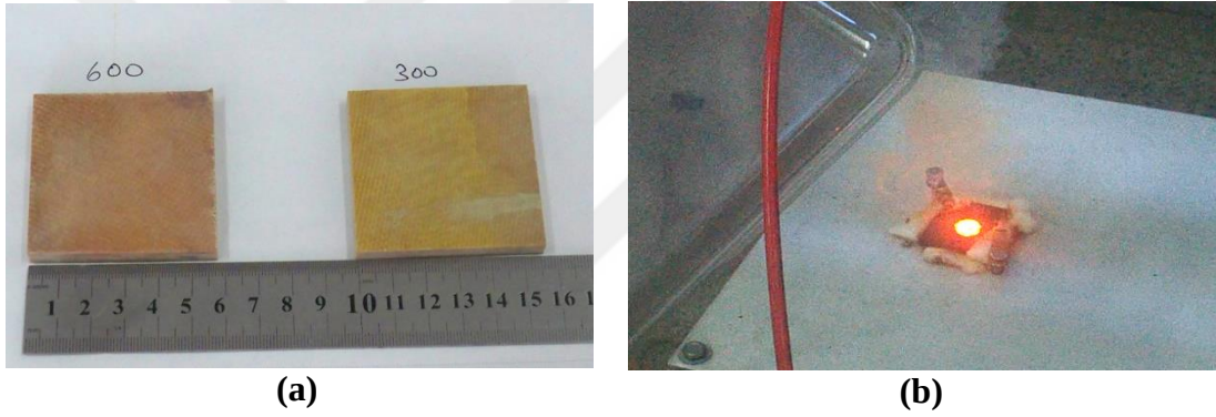
Şekil 5.7 : Statik ısı akısı testi a) test edilen silika-fenolik kompozit numuneler, b) lazerin etkisi ile kompozit numune yüzeyinde gerçekleşen değişim.
