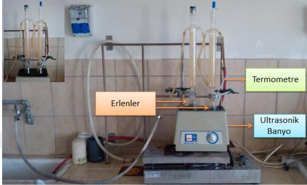
Şekil 5.2 : Çok duvarlı karbon nanotüplerin kimyasal fonksiyonelizasyonu için kurulan düzenek.
