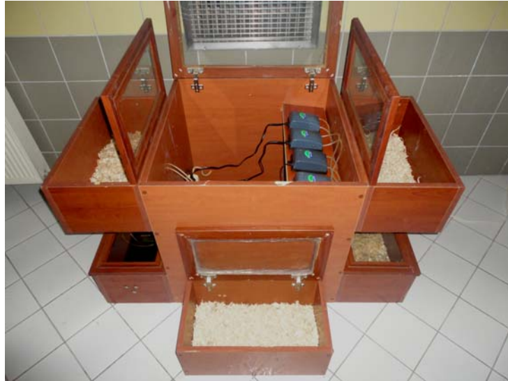
Şekil 6: Sigara dumanına maruz bırakma düzeneği, ön görünüm
