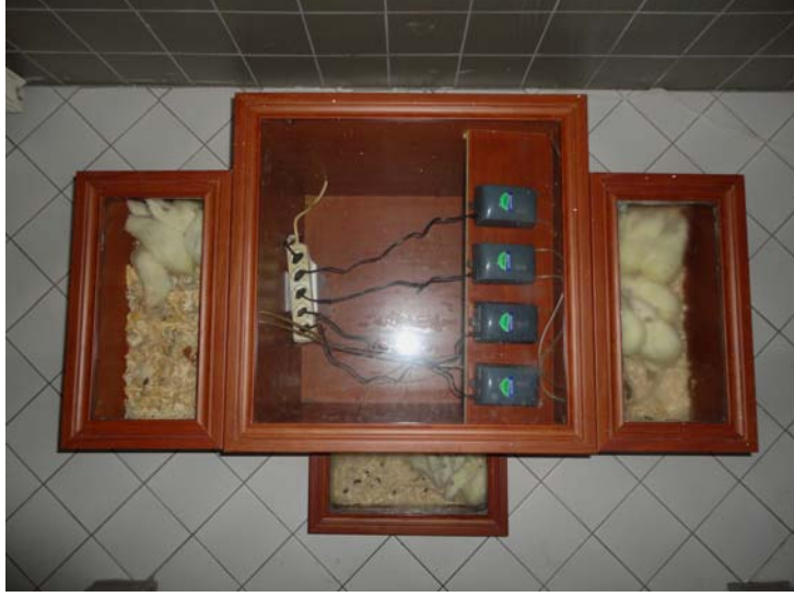
Şekil 7: Sigara dumanına maruz bırakma düzeneği, üst görünüm
