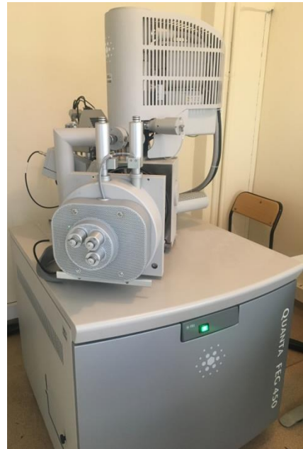
Şekil 3-56: Altın püskürtme cihazı ve taramalı elektron mikroskobu
