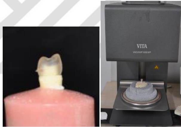
Şekil 3-30: Vita Suprinity örneğin freze sonrası görünümü ve Vita Vacumat fırınına yerleştirilmesi
