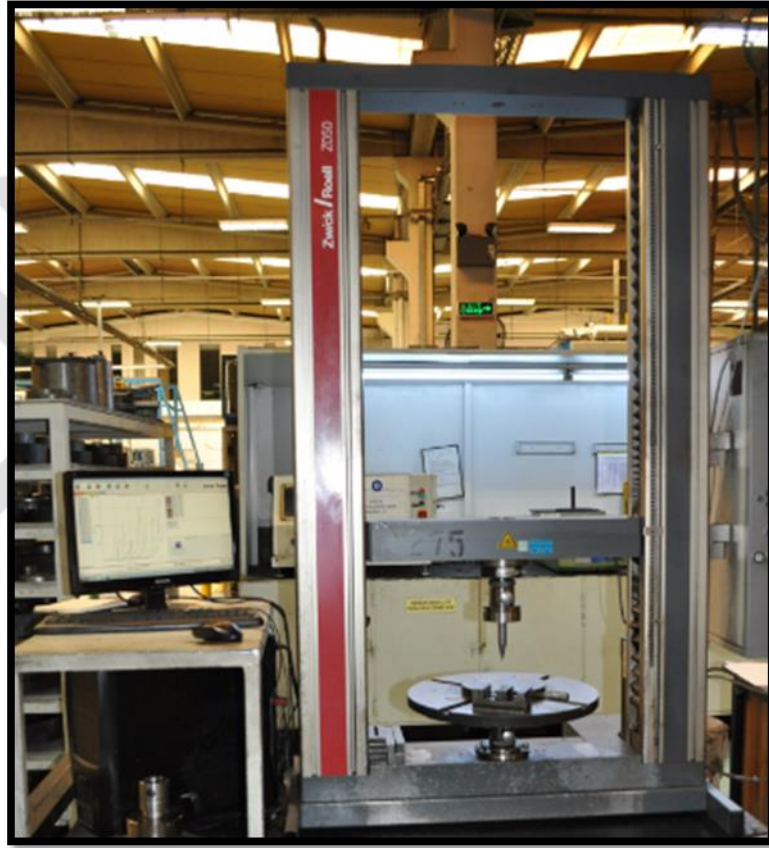
Şekil 3-51: Kırılma dayanımı testinde kullanılan universal test cihazı
