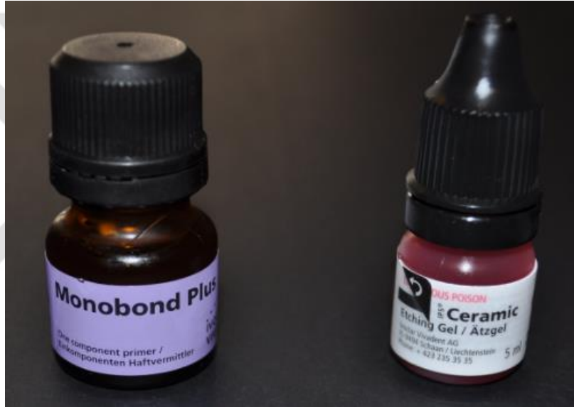
Şekil 3-39: Seramik yüzey hazırlığında kullanılan hidroflorik asit ve silan ajanı
