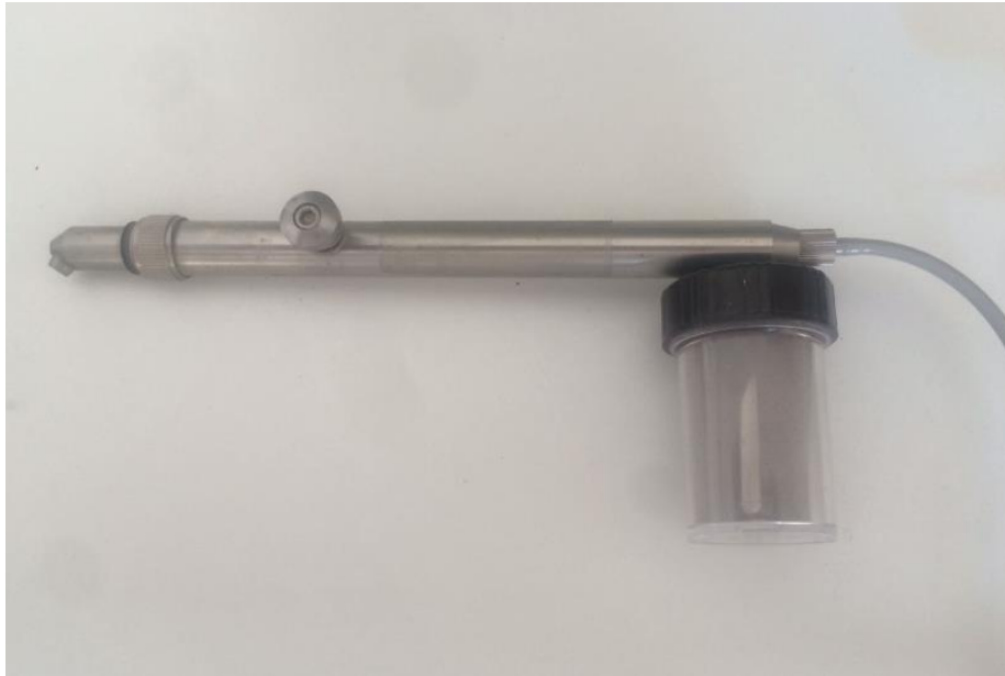
Şekil 3-42: Lava Ultimate kuron restorasyonlarının iç yüzey hazırlığında kullanılan kumlama cihazı
