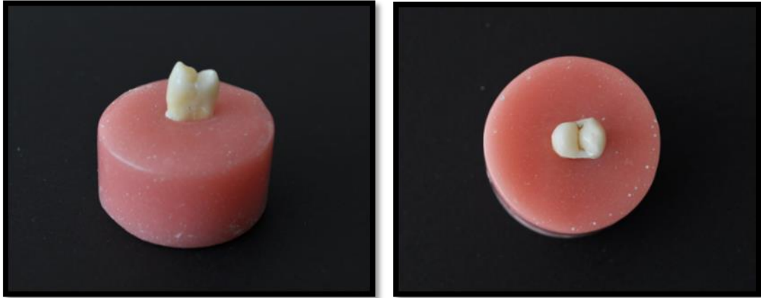
Şekil 3-4: Akrilik reçine içine gömülen diřlerin görünümü
