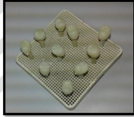
Şekil 3-33: IPS e.max CAD ve Rosetta örneklerin kristalizasyon öncesi ve sonrası görünümü
