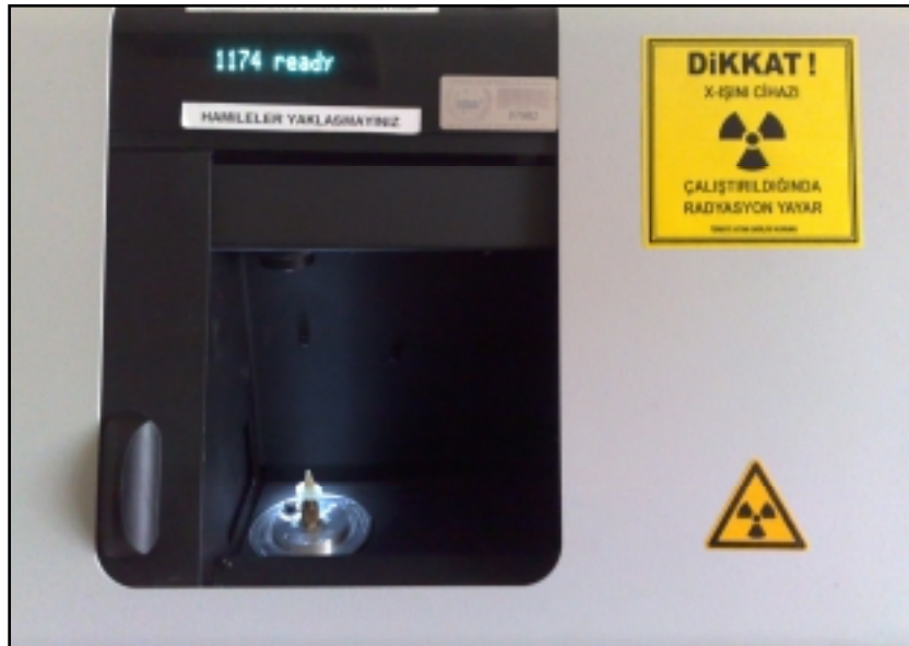
Resim 2.2.3. Köklerin micro-CT cihazına yerleştirilmesi
