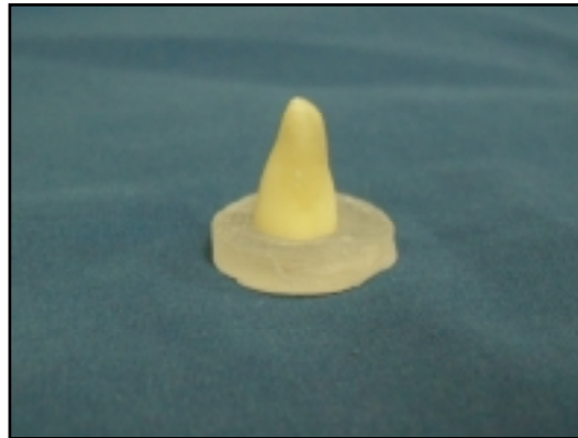
Resim 2.2.1. Köklerin akrilik rezine yerleştirilmesi
