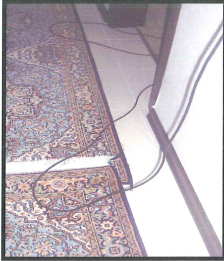
Şekil 3.1 ve Şekil 3.2 : Zeminde takılmaya yol açabilecek kablo ve paspaslar
