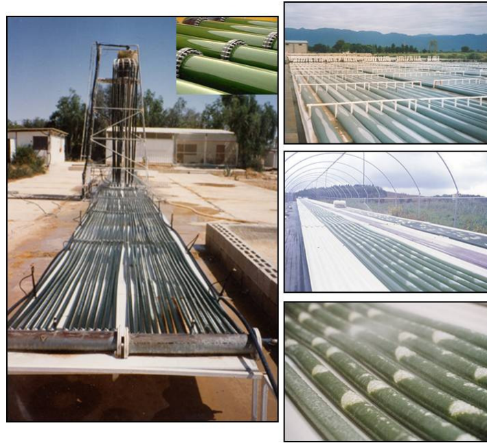
řekil 2.14. Aık ve kapalı atılarda tbler sistemlerde mikroalg kltrasyonu (Tomaselli, 1993 and Tredici, 1999).
