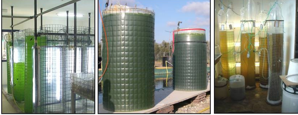
Şekil 2.12. Büyük torbalarda (big bag sistemi) alg üretimi (Tredici, 2007)
