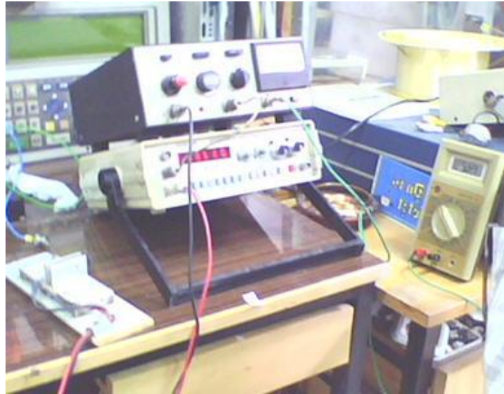
Şekil 5.5. Yüzey gerilimi ölçümü için kullanılan cihaz.
