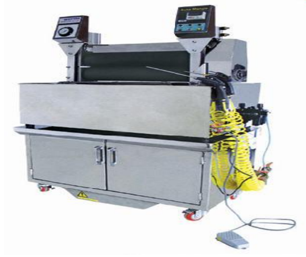
Şekil 5.2. Laboratuvar tipi fular.
