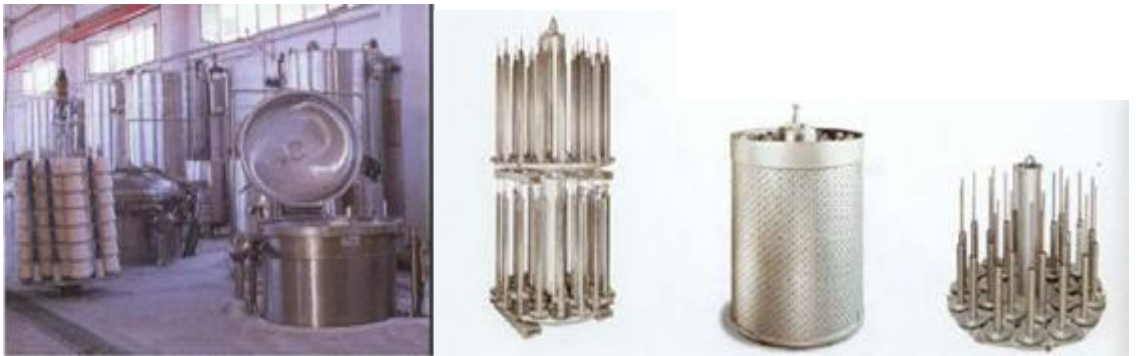
Şekil 2.6. Dikey Gövdeli Bobin Boyama Makinesi ve Portmateryaller.
