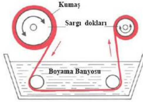
Şekil 2.1. Jigger makinesi çalışma prensibi.
