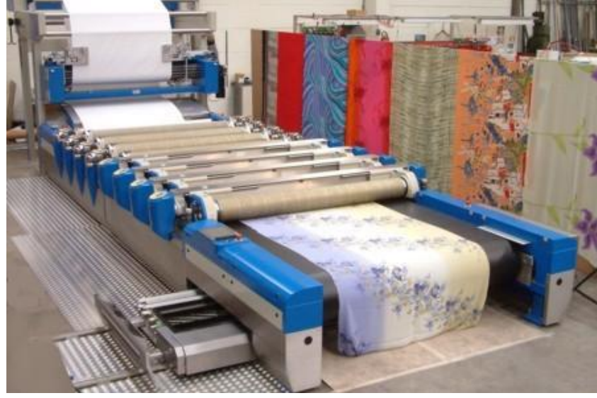
Şekil 2.13. Rotasyon Film Baskı Makinesi.
