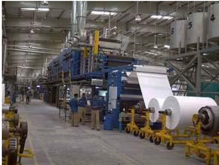
Şekil 2.9. Kontinü boyama yapan makine resmi.
