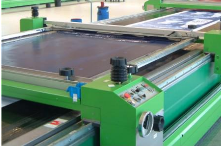
Şekil 2.12. Düz Film Baskı Makinesi.
