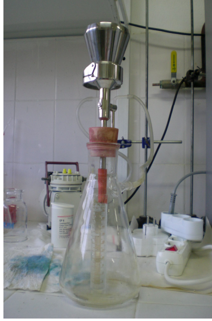
Şekil 3.6. Traverten çamurunun özelliklerinin belirlenmesinde kullanılan vakumlu filtre düzeneği
