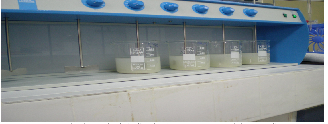
Şekil 3.4. Deneysel çalışmalarda kullanılan hız ve zaman ayarlı jar-test cihazı
