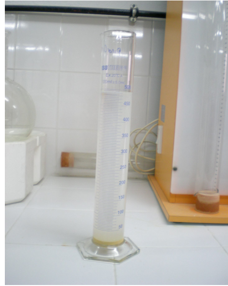
Şekil 3.5. Zamana bağlı olarak süspansiyonun ara yüzey yüksekliğinin ölçümü
