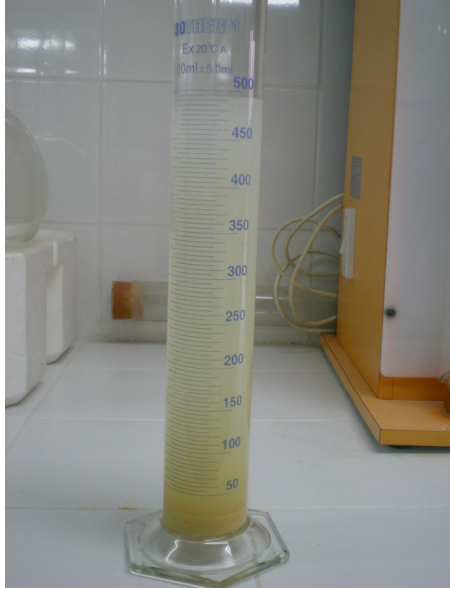
Şekil 3.5. Zamana bağlı olarak süspansiyonun ara yüzey yüksekliğinin ölçümü
