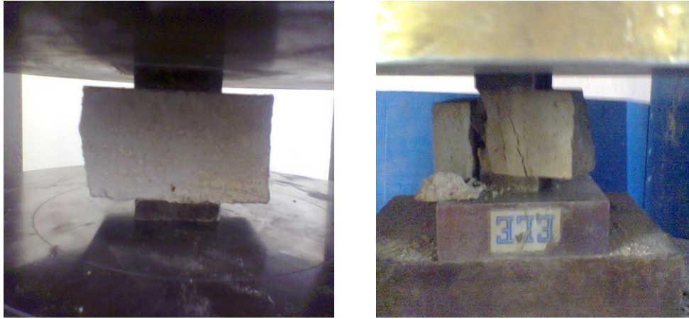
Şekil 3.9. Harç numunelerinde basınç deneyi.
