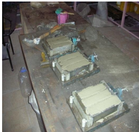
Şekil 3.3. Numunelerin kalıplarda bekletilmesi.
