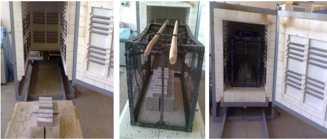
Şekil Ek 2.9. Numunelerin fırına yerleştirilmesi.
