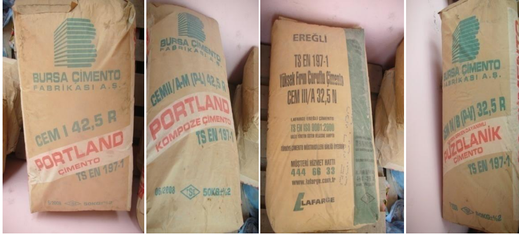
Şekil Ek 2.1. Numune üretiminde kullanılan çimento tipleri.
