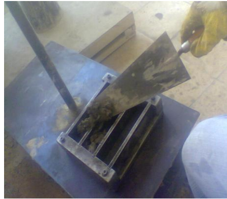
Şekil 3.2. Numunelerin kalıplara yerleştirilmesi.
