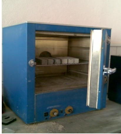
Şekil Ek 2.8. Yüksek sıcaklık öncesi numunelerin etüvde kurutulması.
