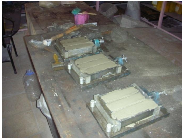
Şekil Ek 2.6. Kalıplara yerleştirilmiş harç numuneleri.
