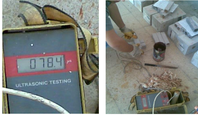
Şekil Ek 2.13. Ultrases geiş süresi deneyi.
