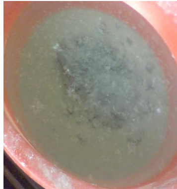
Şekil Ek 2.12. 900 °C sonrası suda soğutma uygulanan harç numunelerinin suda dağılması.
