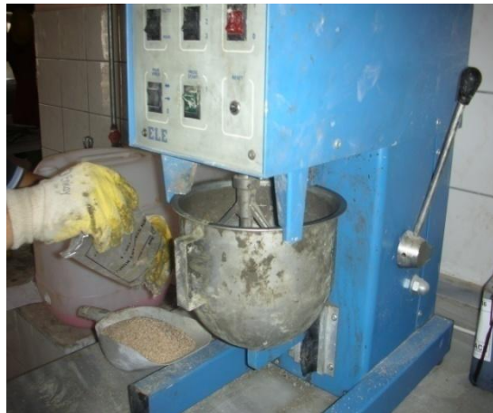
Şekil Ek 2.3. Harçların mikserde karıştırılması.
