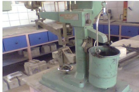
Şekil 3.8. Harç numunelerinde eğilme dayanımı deneyi.
