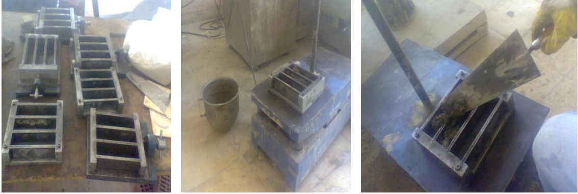
Şekil Ek 2.5. Numunelerin kalıplara yerleştirilmesi.
