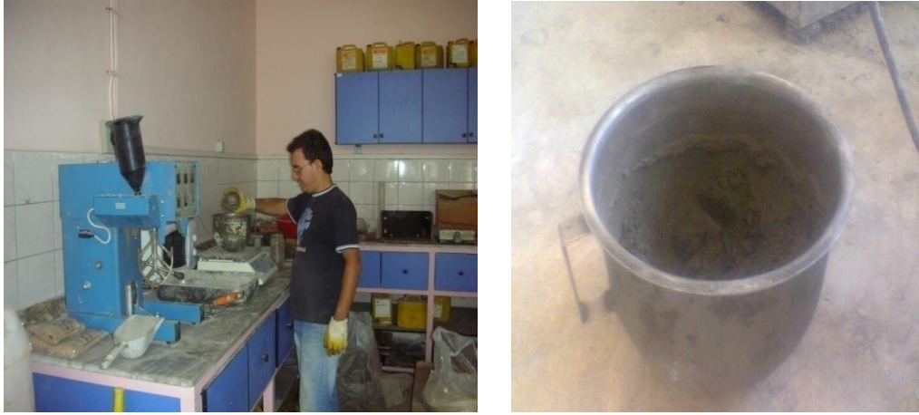
Şekil Ek 2.4. Harç karışımlarının hazırlanması.
