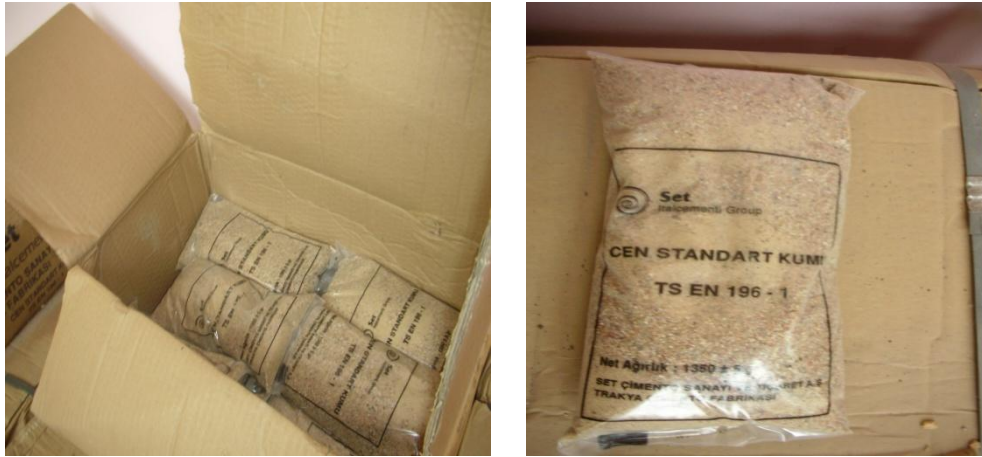
Şekil Ek 2.2. Harç üretiminde kullanılan standart kum.
