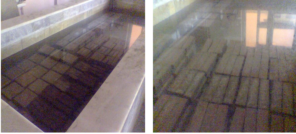
Şekil Ek 2.7. Kür havuzunda bekleyen harç numuneleri.
