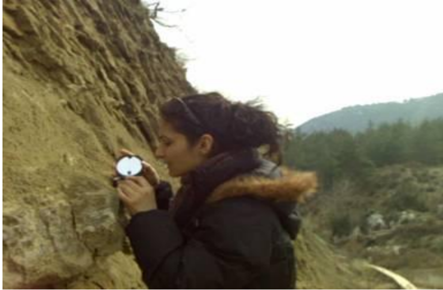
Şekil 3.1. Jeolog pusulası ile doğrultu - eğim ölçümü
