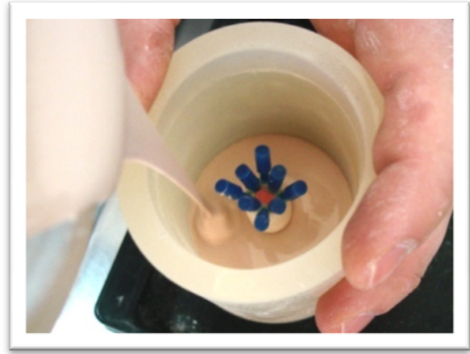
Resim 5.13 Revetmanın vibratör üzerinde dökülmesi (a)
