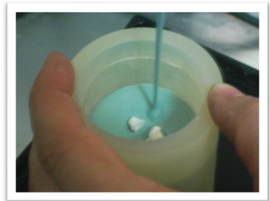
Resim 5.80 Vibratör üzerinde revetmanın doldurulması
