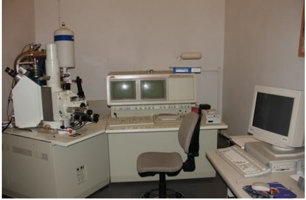
Resim 11: SEM cihazı (JSM 6400-Scanning Electron Microscope, Jeol, Tokyo, Japonya)
