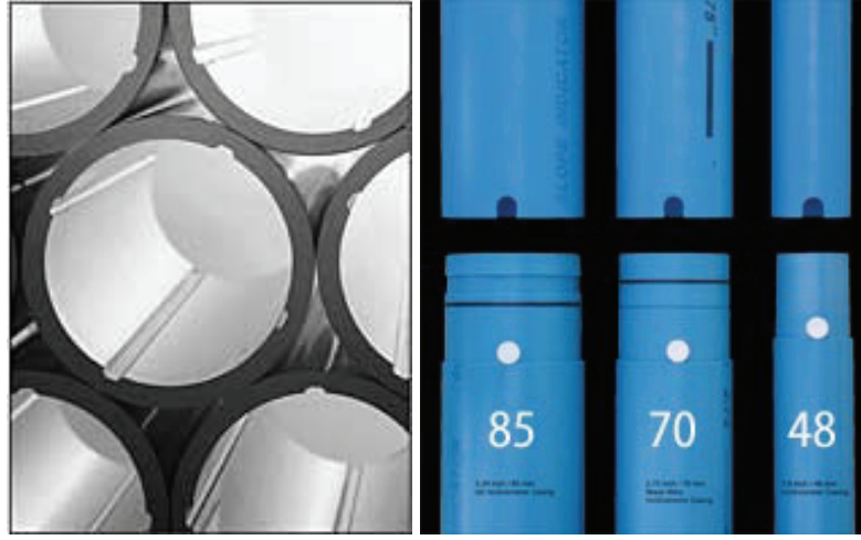
Şekil 3.3 İnklinometre borusunun detayları
